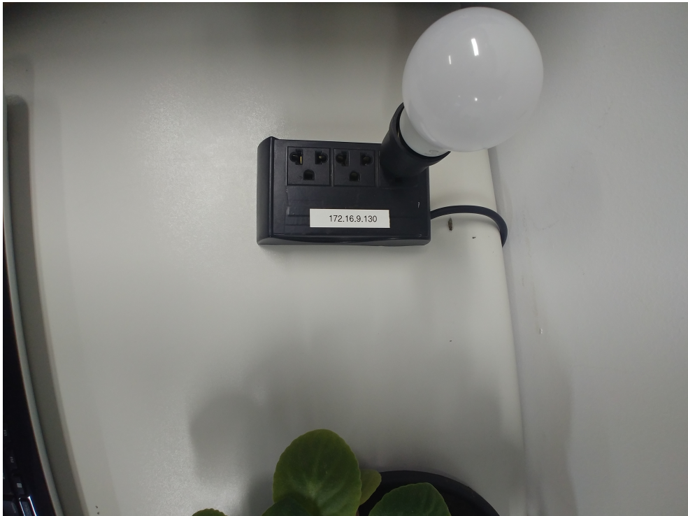
Figura 4.5: Régua inteligente controlada pelo Middleware .
