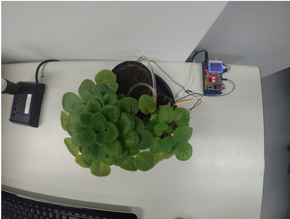
Figura 4.4: Sistema de irrigação controlado de acordo com a umidade do solo.
