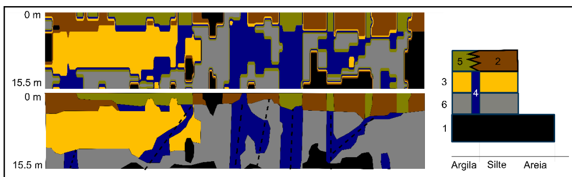
Figura 7.16 – Sessão vertical extraída do modelo para fins de ilustração. Na parte superior, uma sessão interpolada a partir do modelo tridimensional. Na parte inferior, o mesmo modelo com os contornos suavizados. Na parte direita da figura, uma pequena coluna representando a sucessão das classes, junto a suas granulometrias.
