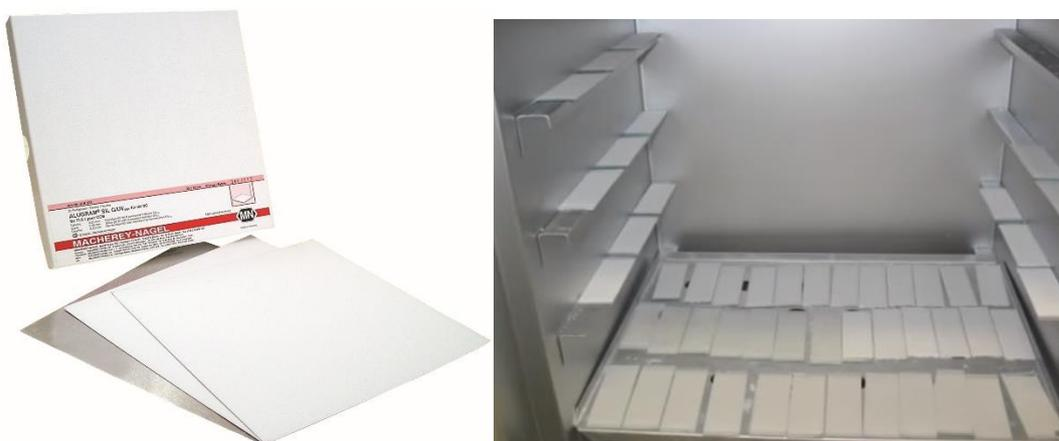
**Figura 5.** Exemplos de placas comerciais (a esquerda) e placas fabricadas em laboratório (a direita), nesta imagem as placas estão secando em estufa, após o procedimento de espalhamento da suspensão de sílica. **Fonte:** placa comercial Macherey-Nagel
