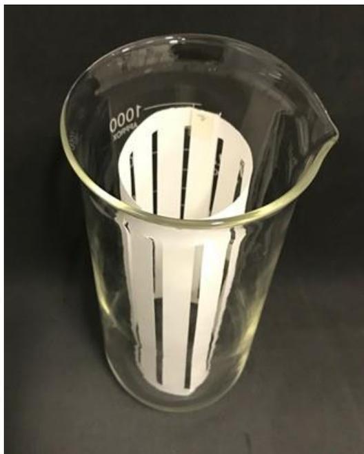
**Figura 13.** Papel em formato cilíndrico posicionado no béquer para a realização da corrida.
