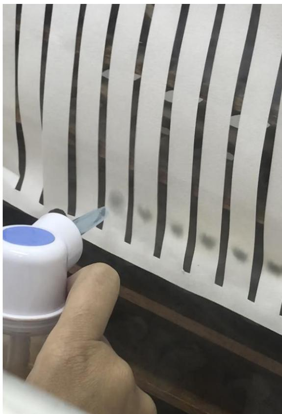
**Figura 14.** Bico adaptado para nebulização da solução reveladora.
