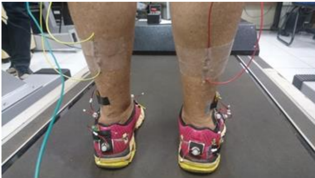
Figura 9 – Posicionamento dos eletrodos para captação da atividade eletromiográfica (EMG) do músculo sóleo de ambas as pernas.
