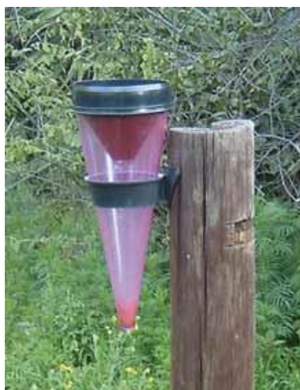
Figura III - Pluviômetro simples utilizado para o monitoramento local baseado na comunidade, na Namíbia. Extraído de Gopa-Cbrlm (2011).
