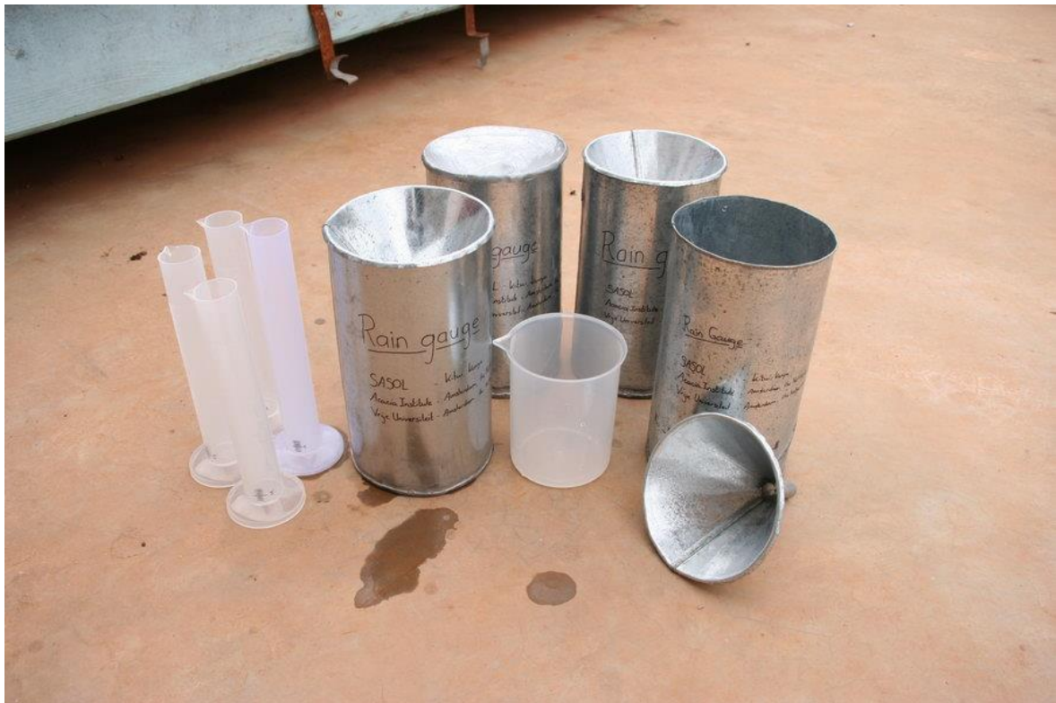
Figura IV - Pluviômetros artesanais utilizados em estudo sobre impactos de barragens subterrâneas, no Kênia. Extraído de Hoogmoed (2007).
