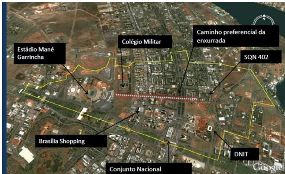
Figura 16 – Bacia de Contribuição Estádio Mané Garrincha.
