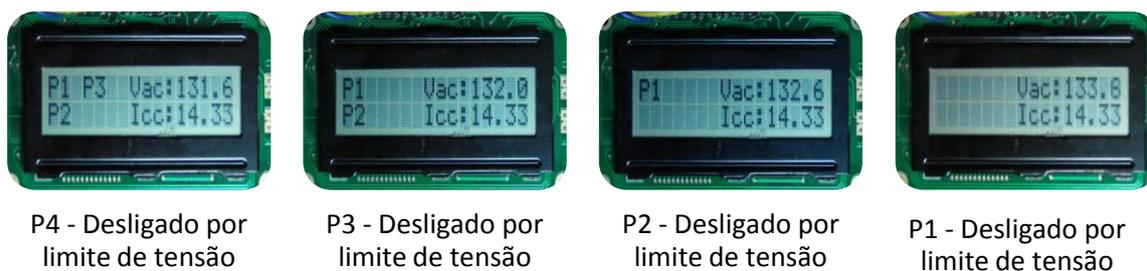
Figura 4.26 - Desligamentos de painel por nível de tensão proteção do algoritmo de controle
