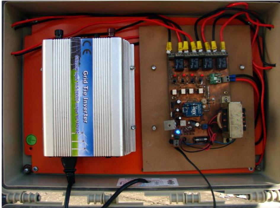
Figura 4.22 - Detalhe do módulo de controle CC, conversores GRID TIE instalados e medidor de energia com todos os canais ativados.
