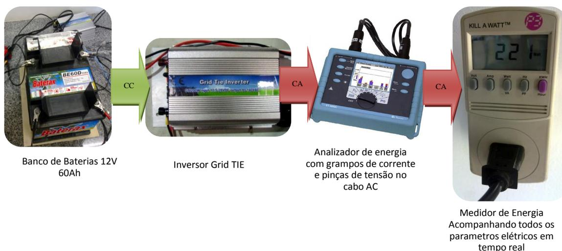
Figura 4.29 - Esquema montado para a experiência de qualidade da energia.
