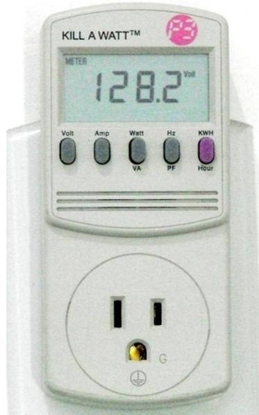
Figura 3.20 - Medidor de energia P4400.
