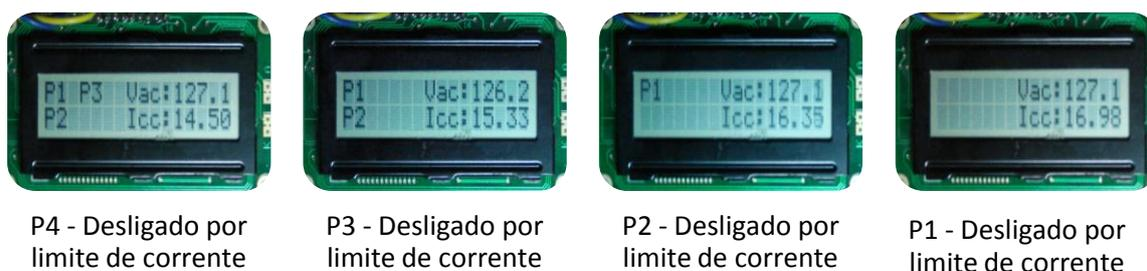
Figura 4.27 - Desligamentos de painel por nível de corrente no barramento CC, proteção do algoritmo de controle.
