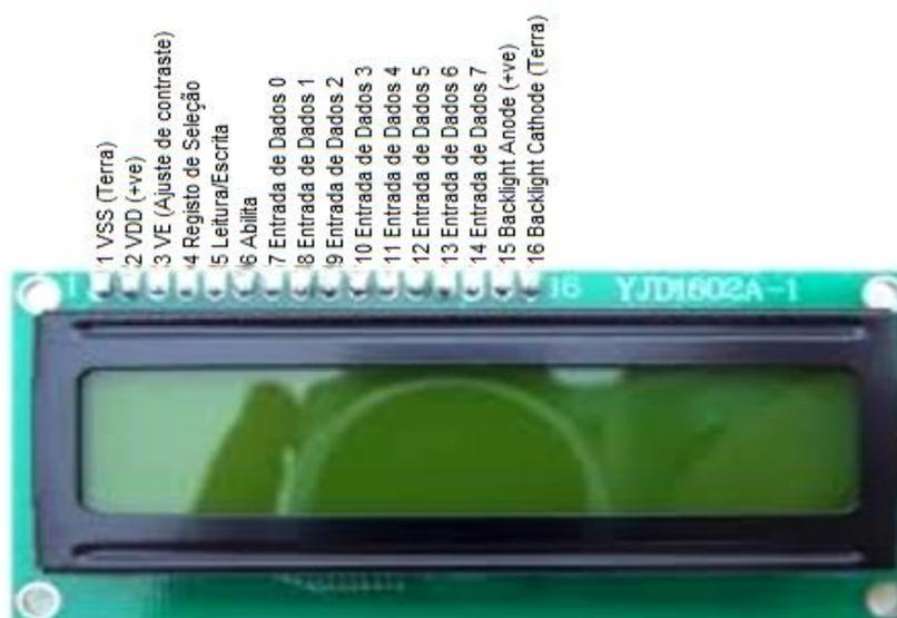
Figura 4.13 - *Pinagem do display de LCD.*
