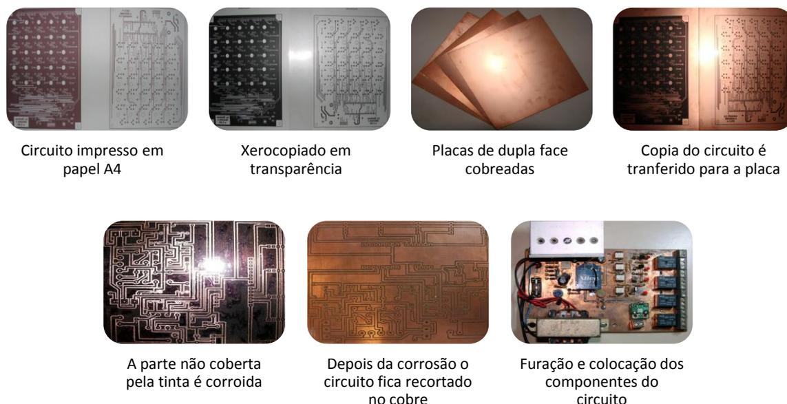
Figura 4.9 - Descrição da confecção artesanal da placa eletrônica do protótipo.
