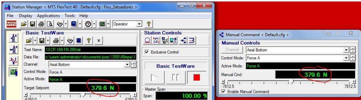
Figura B23: Configuração para aplicação da carga.
