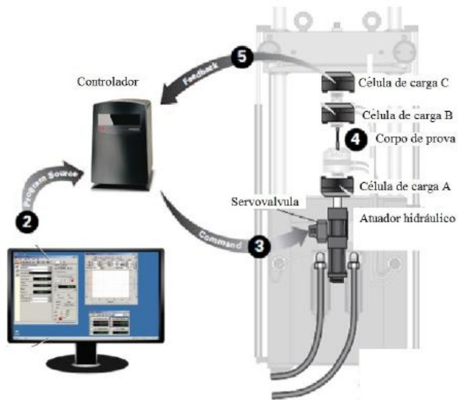
Figura 3.33: Esquema do sistema de controle da máquina MTS (MONROY, 2018).
