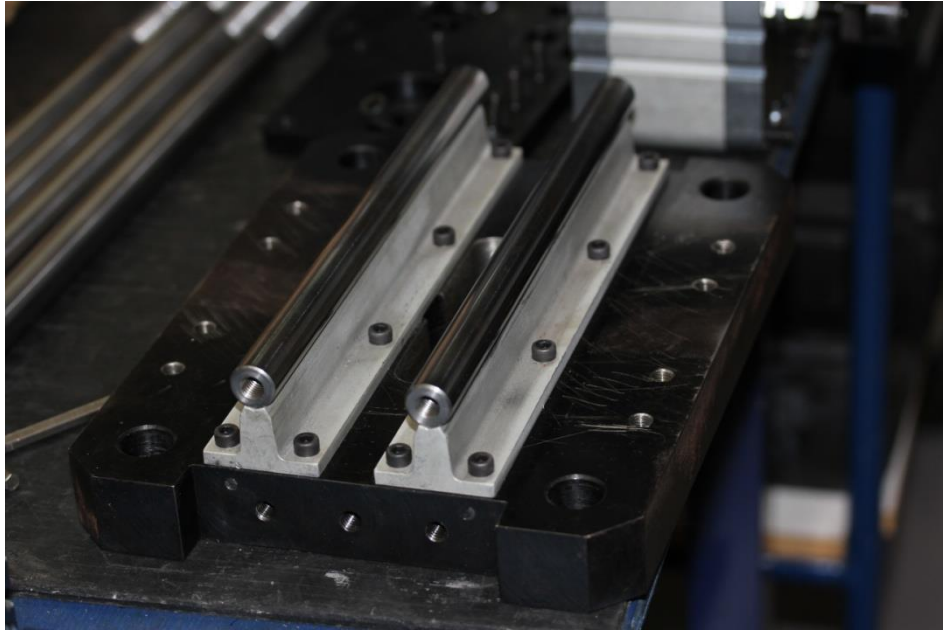
Figura 3.43: Placa de fretting inferior com os trilhos montados.
