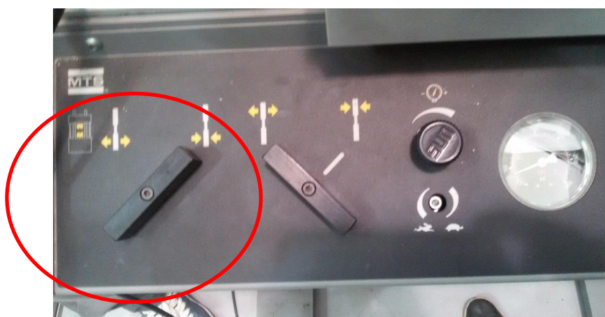
Figura B17: Controle das garras MTS. Garra inferior fechada.
