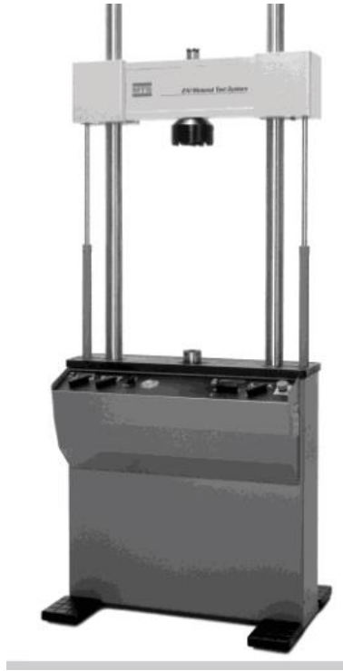
Figura 3.13: Máquina de Ensaio Universal uniaxial MTS 370,02/318,25s (MTS, 2015).
