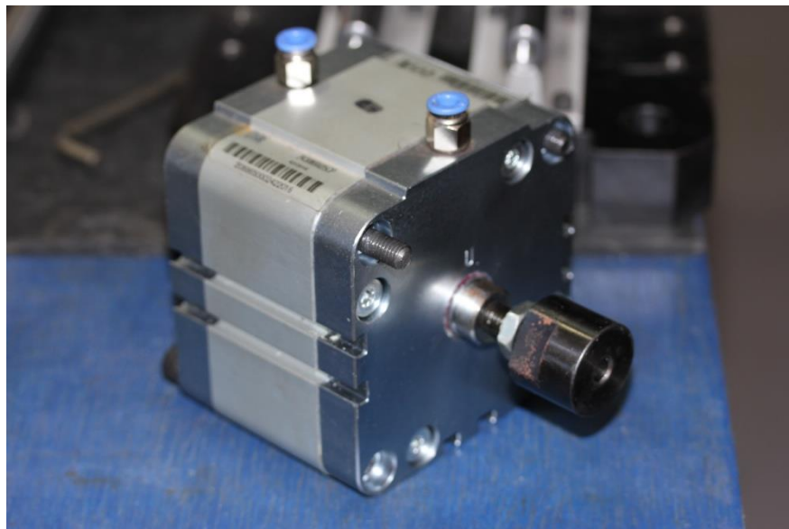
Figura 3.42: Atuador pneumático METALWORK para carga normal P .
