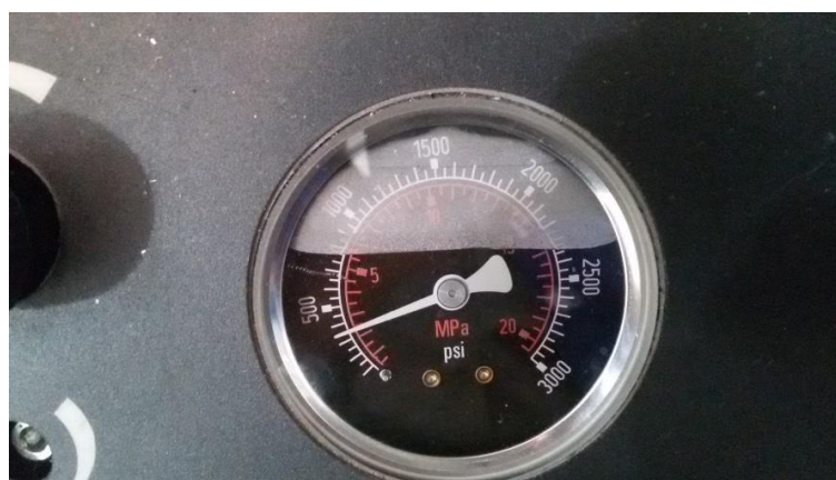
Figura B18: Manômetro de pressão nas garras MTS.
