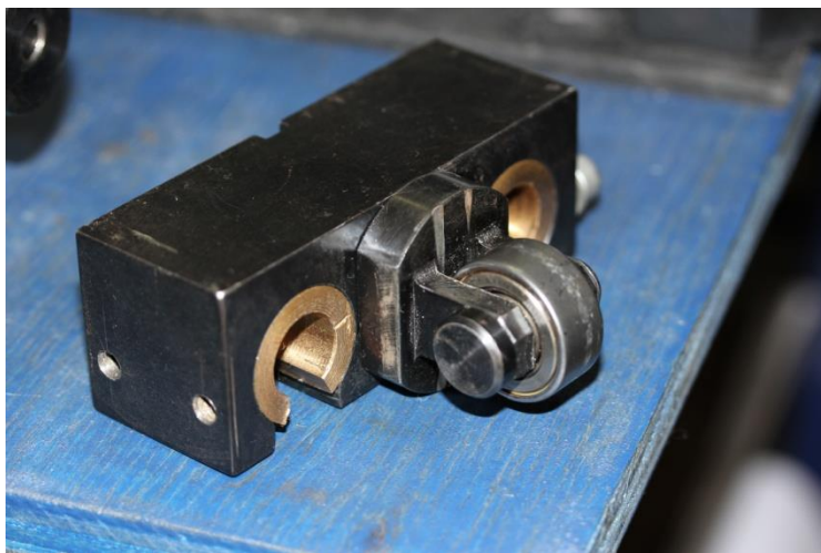
Figura 3.45: Mesa deslizante com rolamento.
