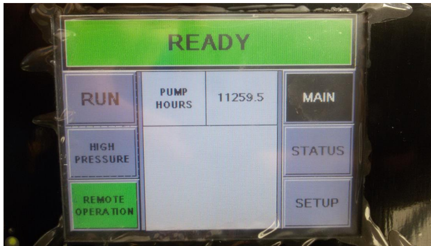
Figura B1: Tela de controle da bomba MTS quando ligada.
