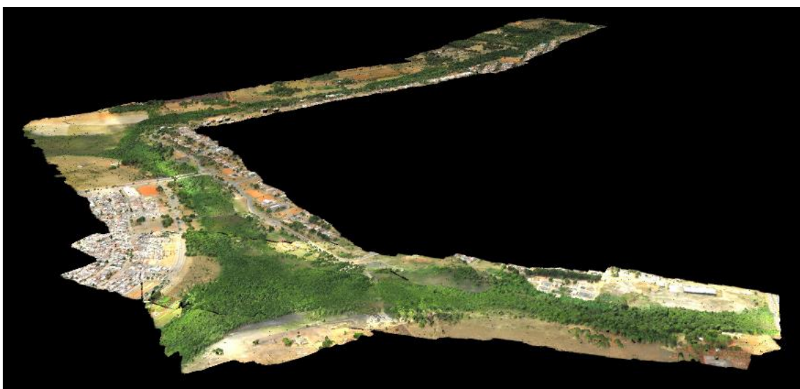
Figura 5 – Modelo gerado a partir de nuvem de pontos obtida após processamento de levantamento topográfico da região do Ribeirão Sobradinho.
