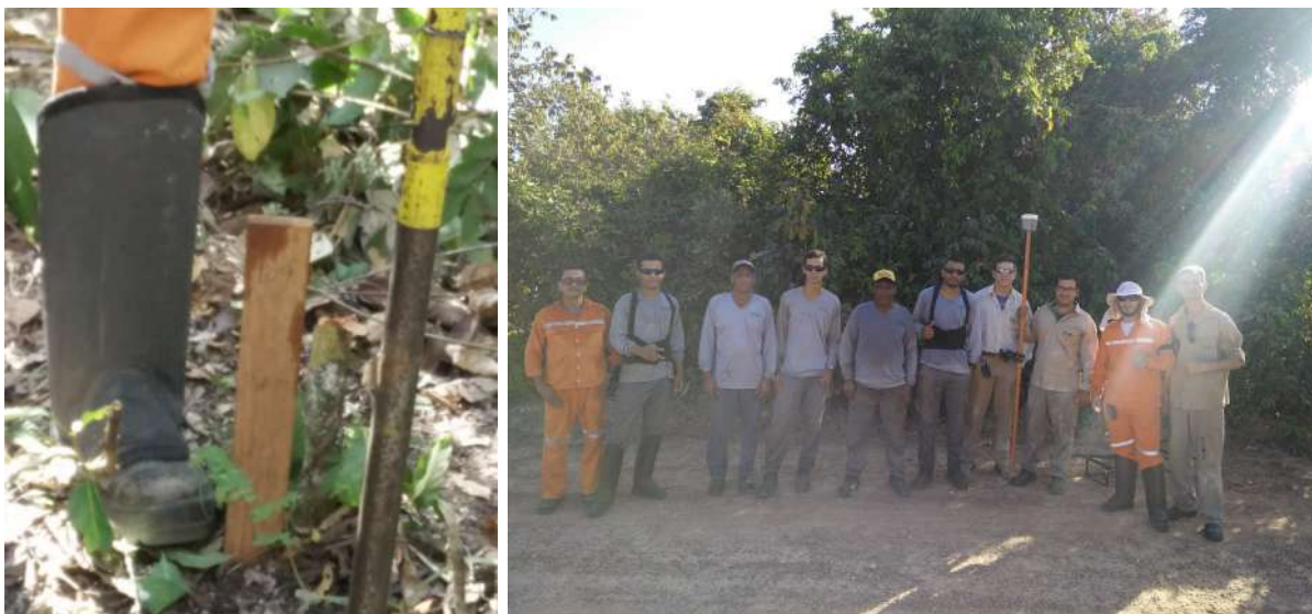
Figura 6.1: Fotos evidenciam uma estaca usada para indicar o ponto para a perfuração e a equipe de topografia que atuou no projeto.
