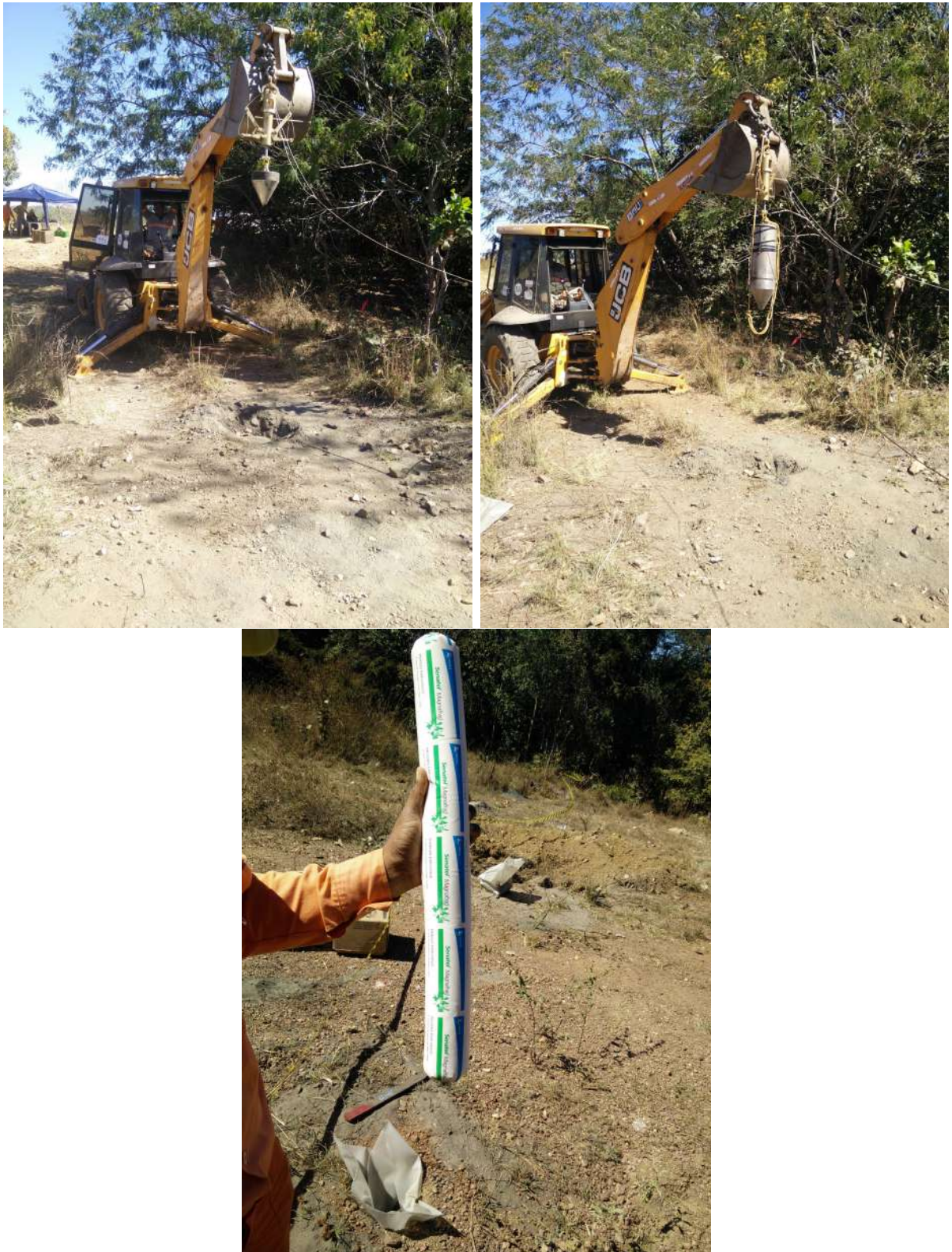
Figura 3.2: Fotografias evidenciam as fontes de onda sísmica utilizadas nos testes de fonte. a) Queda de peso de 60 kg. b) Queda de peso de 300 kg. c) Cargas Explosivas de ANFO.
