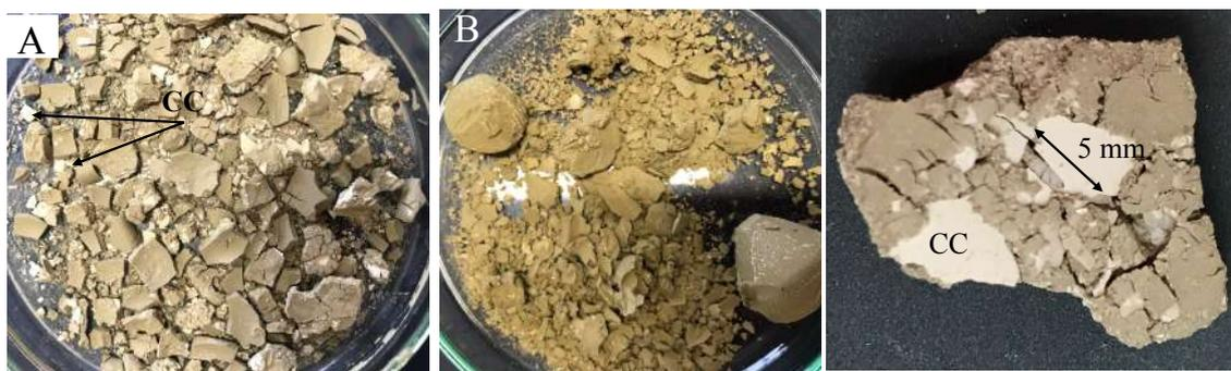
Figura 4-20. Evidência visual da cimentação da bentonita biotratada e comparação com o controle negativo. A) bentonita biotratada com *B. cohnii*, com textura mosqueada pela precipitação de CC. B) amostra de bentonita controle C) bentonita com CC de hábito lamelar.
