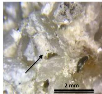
b) Imagem no estereoscópio, 3X. Amostra de areia de quartzo biocimentada com *S. pasteurii*. Grãos de quartzo cimentados com minúsculos cristais de carbonato ligados e formando uma camada fina.
