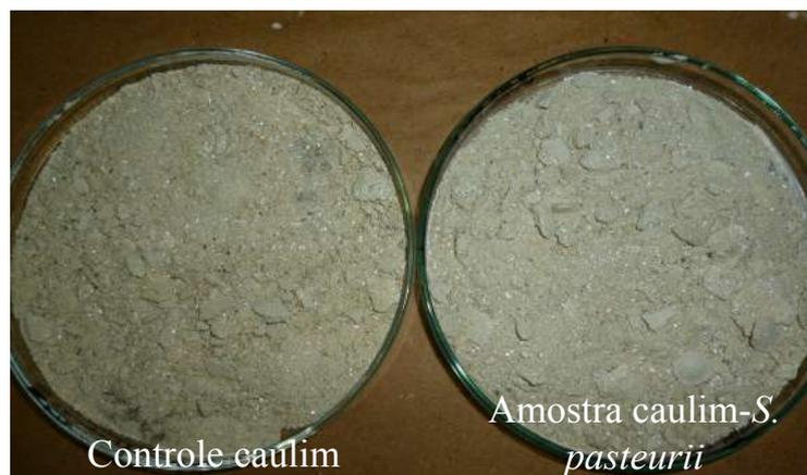
Figura 4-22. Comparação amostras de caulim depois do tratamento. Amostra controle caulim e amostra caulim biotratada com *S. pasteurii*, sem evidencia de cimentação.
