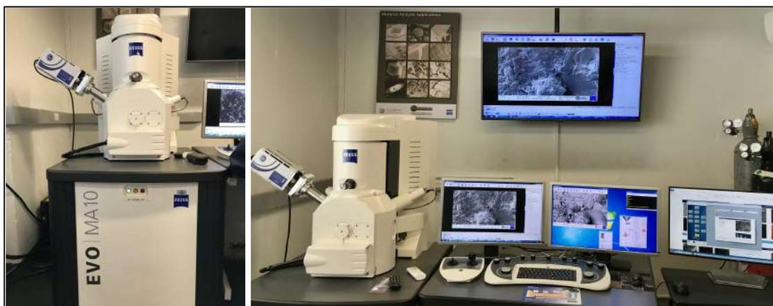
Figura 3-4. Microscópio Eletrônico de Varredura do Laboratório de Biomateriais, da UNAL.
