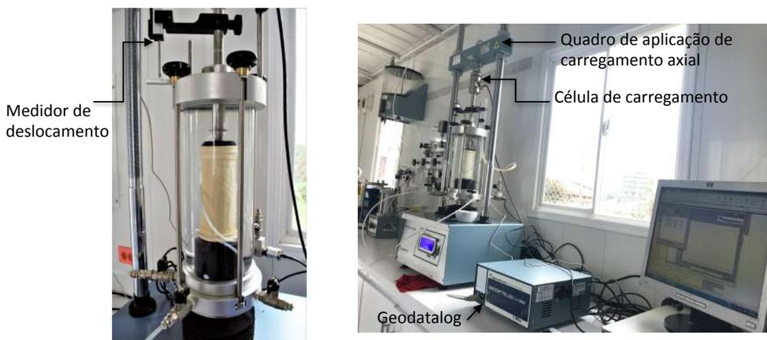
Figura 3-9. Equipamentos utilizado no ensaio triaxial, estágio de cisalhamento.
