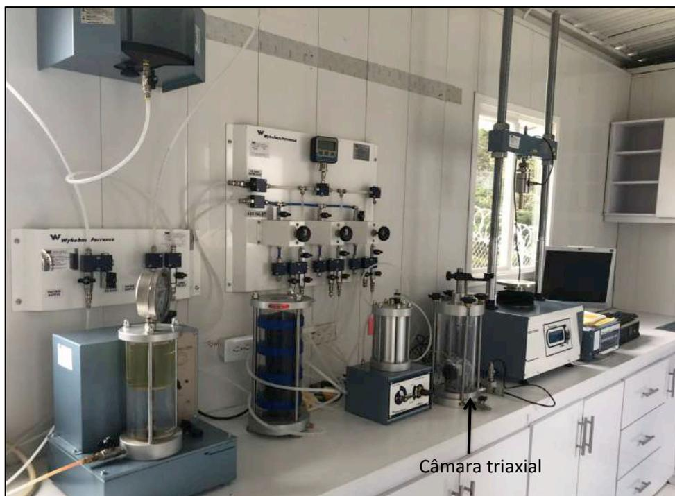
Figura 3-7. Equipamento triaxial do Laboratório de solos, PCJIC.
