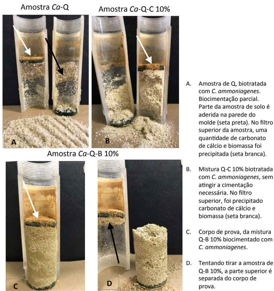
Figura 4-68. Amostras biotratadas com *C. ammoniagenes*, com biocimentação parcial do volume total das amostras. A) areia de quartzo (Q). B) mistura Q-C 10%. C-D) mistura Q-B 10%.
