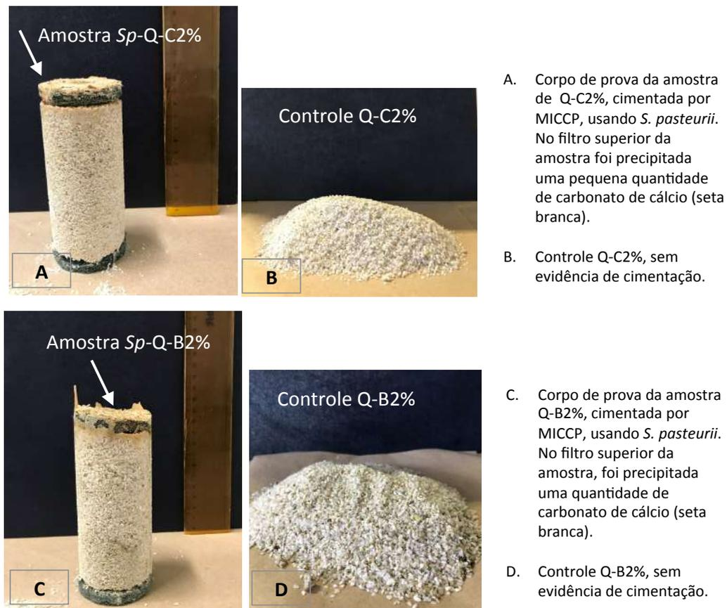
Figura 4-91. Imagens das amostras ao final do ensaio de biocimentação. (A) amostra *Sp-Q-C2%*. (B) controle Q-C2%. (C) amostra *Sp-Q-B2%*. (D) controle Q-B2%.
