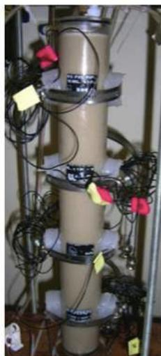
a) Colunas cilíndricas de 50 cm de altura.
