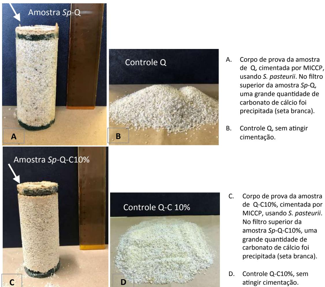
Figura 4-65. Imagens das amostras de Q e mistura Q-C10% ao final do tratamento de biocimentação. (A) amostra *Sp-Q* biocimentada transformada numa areia muito compacta, semelhante a um arenito. (B) controle Q sem apresentar cimentação. (C) mistura Q-C 10% biocimentada com *S. pasteurii*. (D) controle Q-C10% sem evidência da precipitação de carbonato de cálcio.
