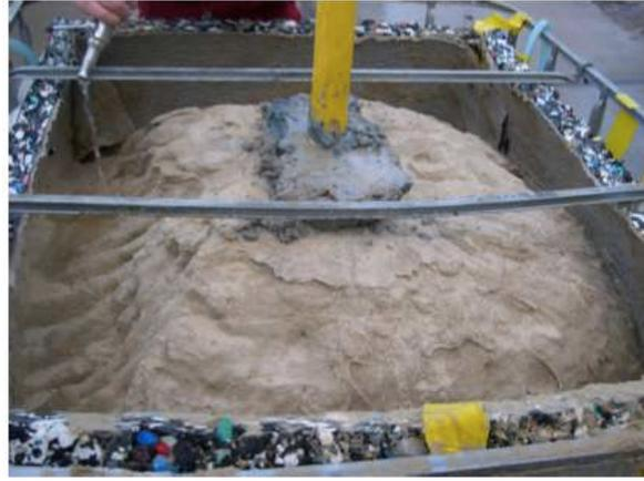
b) Superfície do corpo de areia biocimentado. Cume com alto conteúdo de carbonato visível na esquerda.
