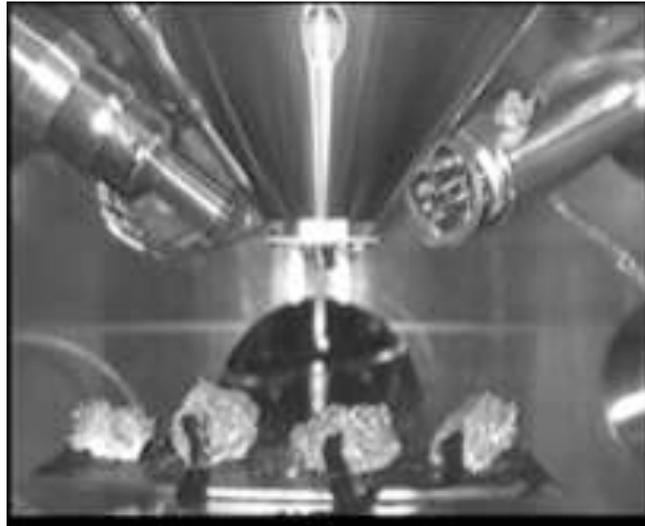
Figura 4-72. Montagem no MEV dos torrões das amostras biocimentadas de Q e Q-C10% com *S. pasteurii*.
