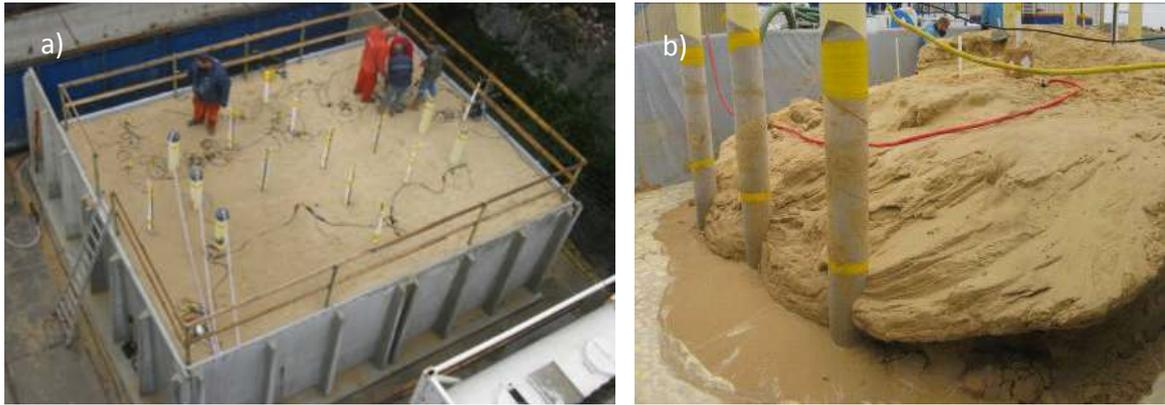
Figura 2-24. *Biogrout* a corpo de areia de 100 m<sup>3</sup>. (a) Caixa de concreto com areia, 3 poços de injeção à esquerda e 3 poços de extração à direita. (b) corpo de areia biocimentado, com padrões de cimentação seguindo as linhas de fluxo. (Van Paassen, 2009).
