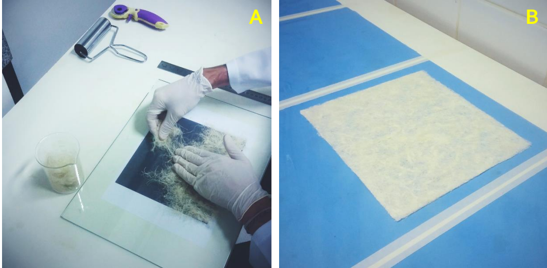
Figura 3.3 – Processo de produção das mantas de fibras de curauá (a). Manta finalizada e pronta para processo de impregnação (b).
