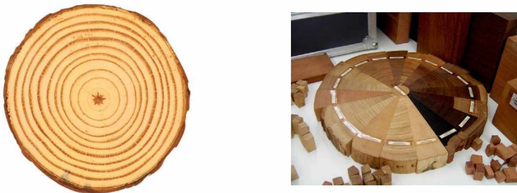
Figura 2.3 - Anéis de crescimento. Imagens: LPF
