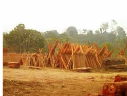
Figura 2.15 - Empilhamento horizontal e tipo tesoura em processo de secagem natural de madeira. http://www.ibama.gov.br/images/Recursos_Florestais , http://www.madeireirafalsarella.com.br/
