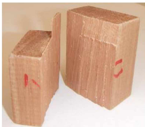
Figura 2.7 - Madeira de grã direita e revessa. Imagens: (MELO,2014)
