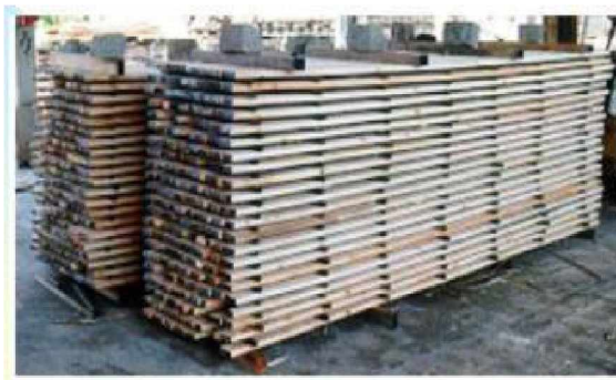
Figura 2.15 - Empilhamento horizontal e tipo tesoura em processo de secagem natural de madeira. http://www.ibama.gov.br/images/Recursos_Florestais , http://www.madeireirafalsarella.com.br/
