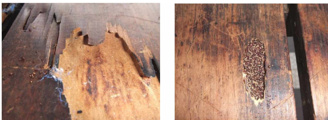
Figura 2.18 - Galerias e fezes de cupins de madeira seca. (MELO,2014)
