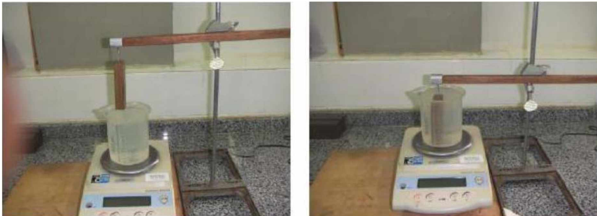
Figura 1.1 - Equipamento para determinação de volume do corpo de prova, por imersão em água, para determinação da densidade básica. Imagens: Julio Melo
