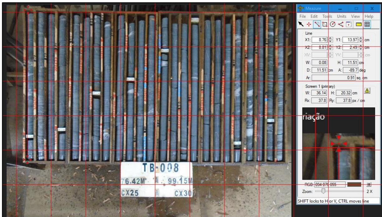
Figura 5.4: Interface do *software meazure*, utilizado para medição dos intervalos maiores ou iguais a dez centímetros e contagem do número de fraturas, por intervalo geomecânico previamente definido.
