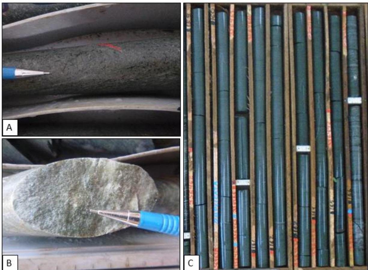
Figura 5.5: Imagens de algumas feições observadas ao longo das descrições, sendo que na Figura A tem-se os cristais de anfibólio, que marcam a ocorrência da metagrauvaca. Já na Figura B tem-se a parede de uma descontinuidade do QSST. Não menos importante, na Figura C é representado um intervalo de ocorrência do diorito.
