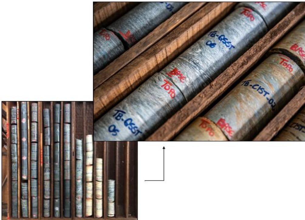
Figura 5.12: Amostras selecionadas para campanha de ensaios a ser realizada na região da cava Três Buracos.
