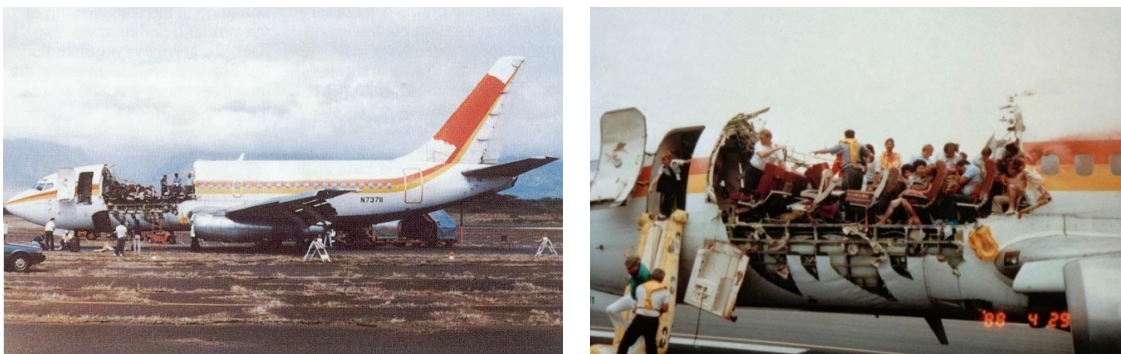
Figura 1.1 – Falha por fadiga da fuselagem do Boeing 737-200
