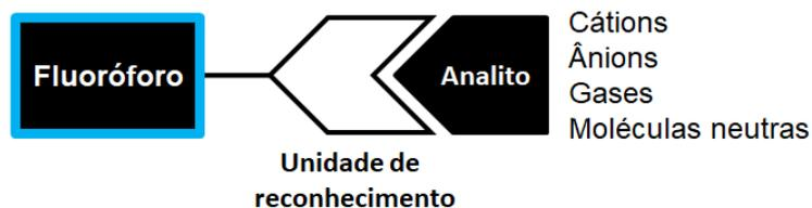
Figura 1. Esquema simplificado de um quimiossensor, adaptado de Valeur.<sup>5</sup>
