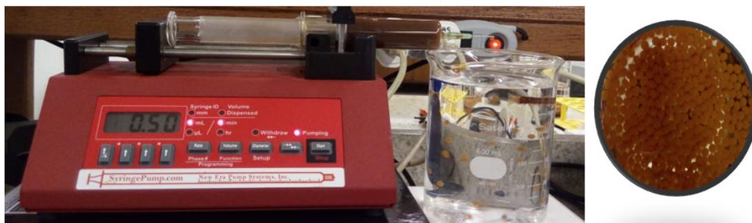
**Figura 6** - Sistema para preparo das microesferas magnéticas.
