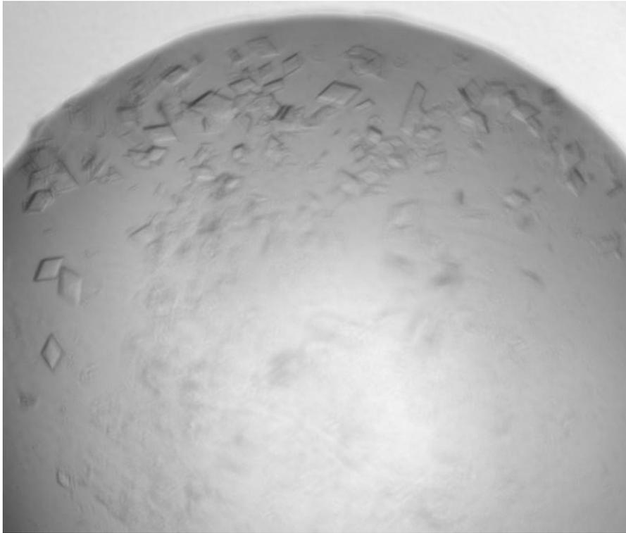
**Figura 29.** Cristais de VapC20 em uma gota de 200 nL obtidos a partir do ensaio com kit Crystal Screen HR2-112 (Hampton Research). A condição de cristalização foi fosfato de potássio citrato 0,1 M, pH 4,2, cloreto de sódio 0,2 M, PEG 8000 20 % m/v.
