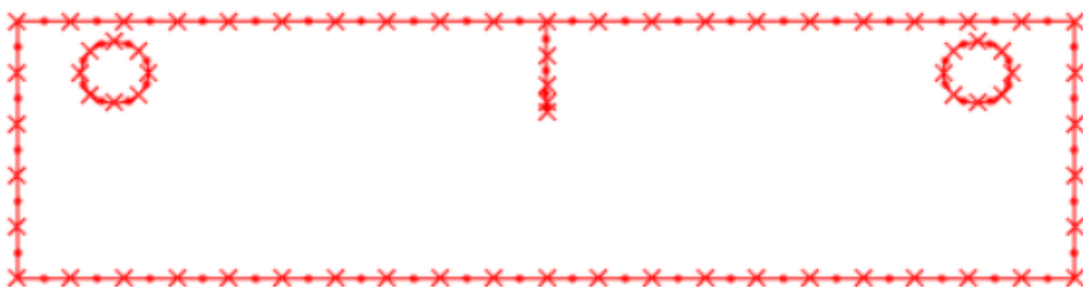
Figura 6.4: Malha de elementos de contorno do CP01.
