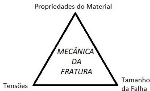
Figura 2.1: Triângulo da Mecânica da Fratura.
