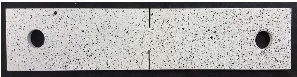
Figura 5.14: Padrão Speckle no Corpo de Prova.
