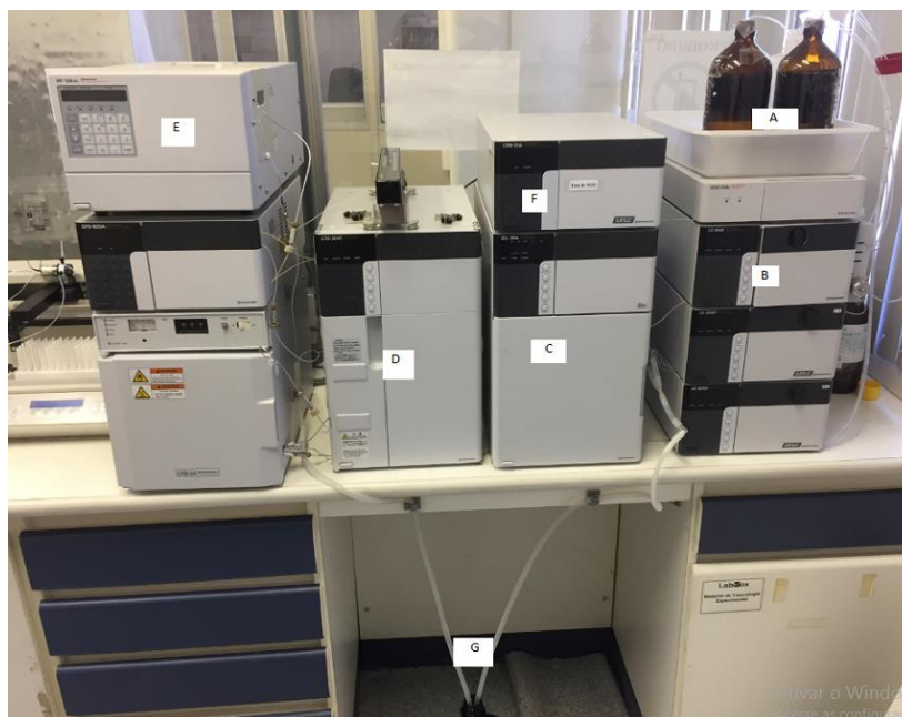
Figura 22. Sistema cromatográfico Shimadzu® do Laboratório de Toxicologia: a) reservatório da fase móvel; b) bomba de alta pressão; c) injetor; d) coluna; e) detector; f) módulo comunicador; e g) resíduos.
