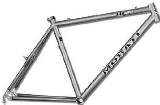
Figura 7. Quadro de bicicleta de liga de titânio Ti-6Al-4V pesando somente 1,45Kg (adaptado de Leyens e Peters, 2004).
