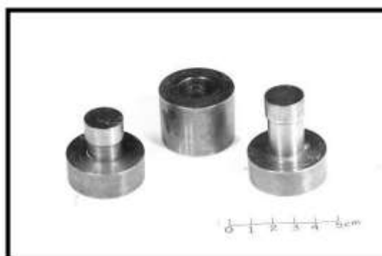
Figura 54. Matrizes de aço com camisa flutuante utilizada na prensagem uniaxial a frio para a liga Ti-12Cr.
