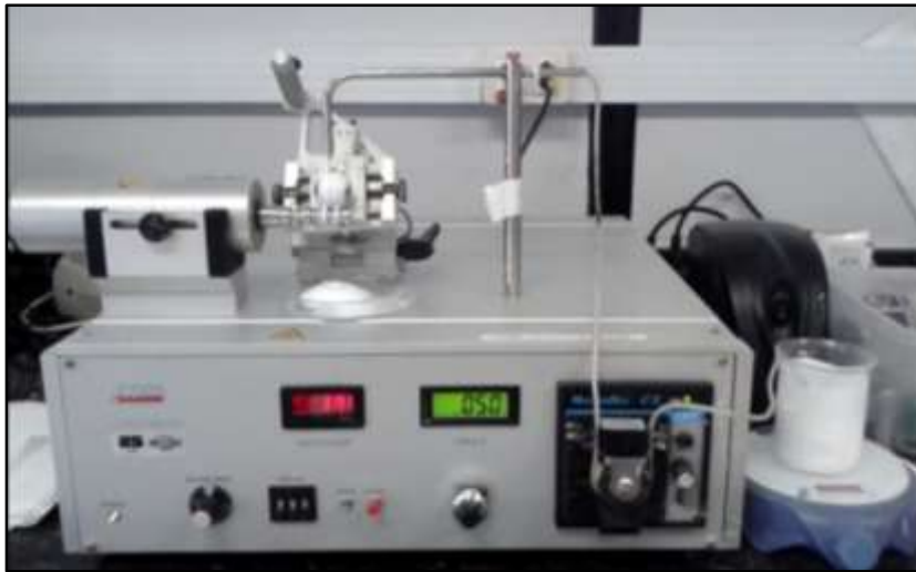
Figura 65. Equipamento de ensaio de desgaste microabrasivo por esfera rotativa livre utilizada no presente trabalho.
