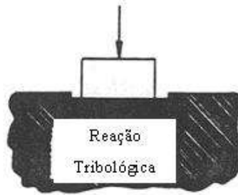
Figura 35. Sistema esquemático do desgaste corrosivo.
