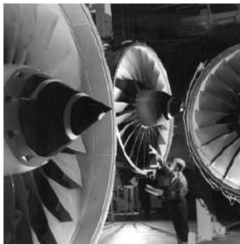
Figura 8. Ventoinhas frontais de motores comerciais feitos de Ti-6Al-4V (adaptado de Leyens e Peters, 2004).
