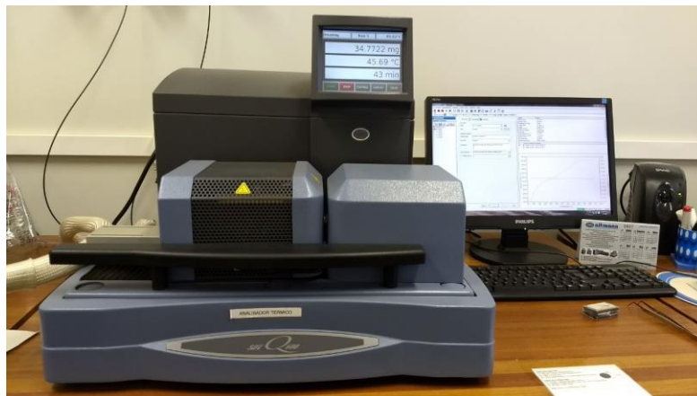
Figura 4.4: Analisador Térmico utilizado para levantamento das temperaturas de tratamento e fusão.
