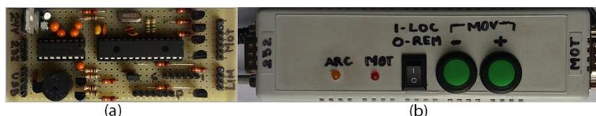
**Figura 2. Prototipo de la interfaz de adquisición de datos y control en lazo abierto:
