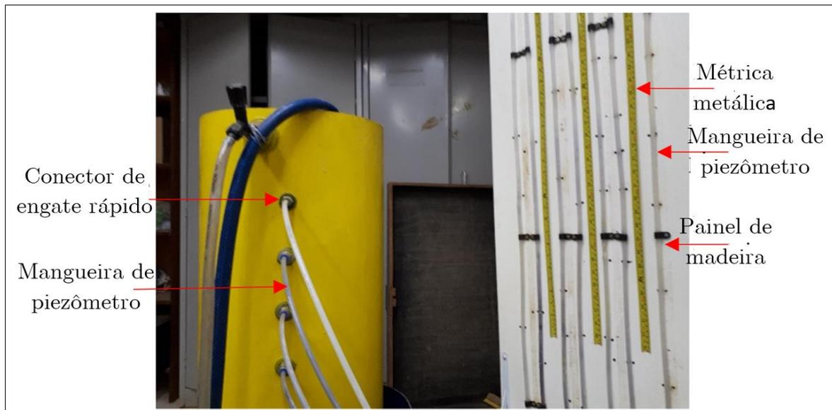
Figura 3.4 – Instalação dos piezômetros.
