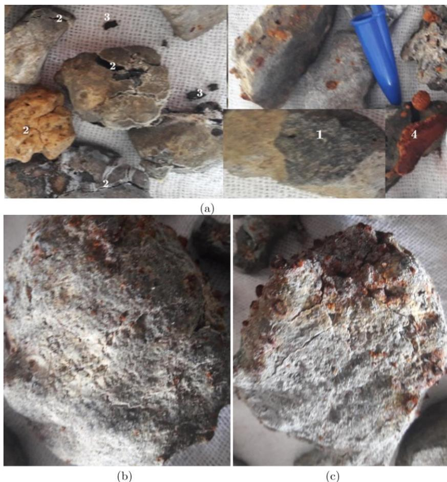
**Figura 4.28** – Alterações das amostras - LD, após imersão em água: a) fratura, desintegração e oxidação; b) imagem ampliada do processo de oxidação; c) imagem ampliada do processo de oxidação seguida de fratura e desintegração da amostra
