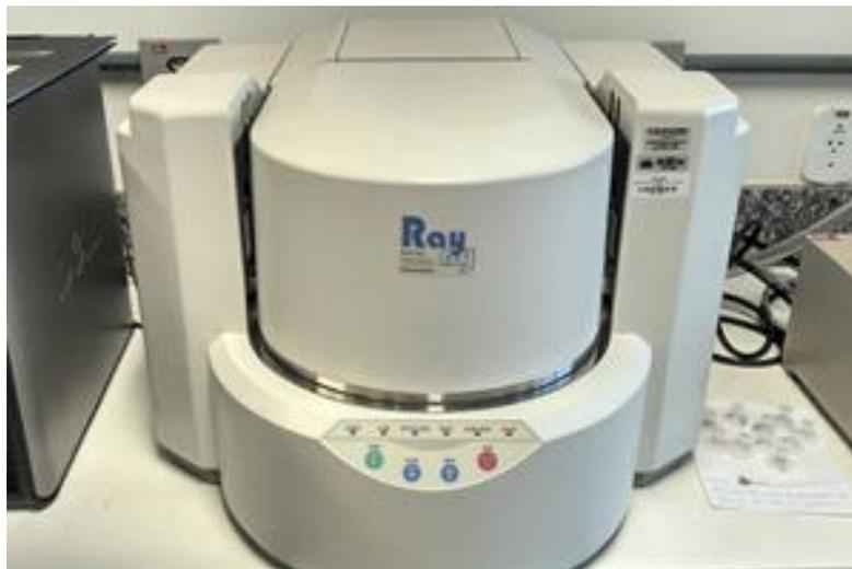
Figura 3.14 – Expectômetro de fluorescência de Raios X.
