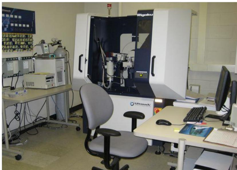
Figura 3.13 - Difratorômetro de Raios X
