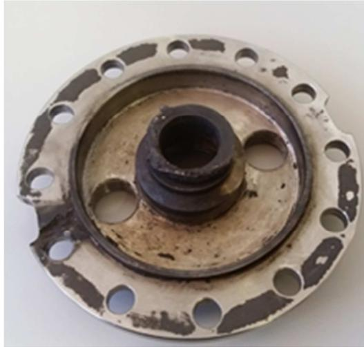
Figura 6: Peça do conjunto da placa injetora do motor SARA parcialmente danificada após teste
