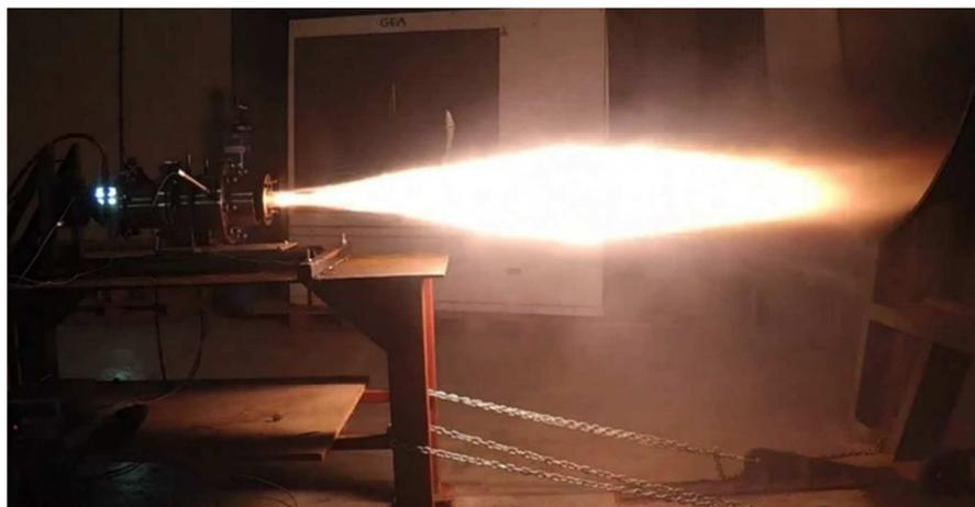
Figura 24: Motor ULBHRE instalado na bancada durante o procedimento de teste
