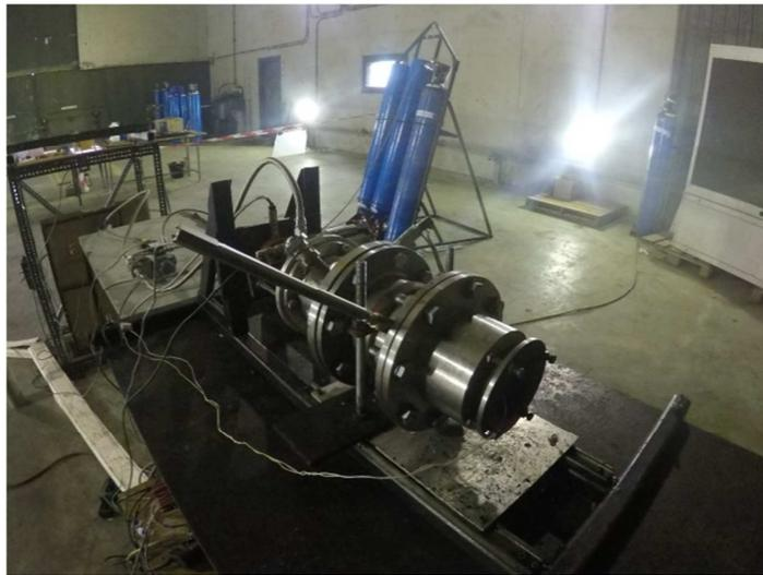
Figura 4: Motor foguete híbrido do ATM-ULB
