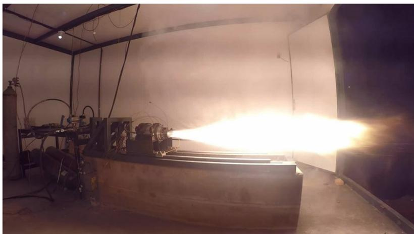
Figura 18: Motor SARA instalado na bancada durante o procedimento de teste
