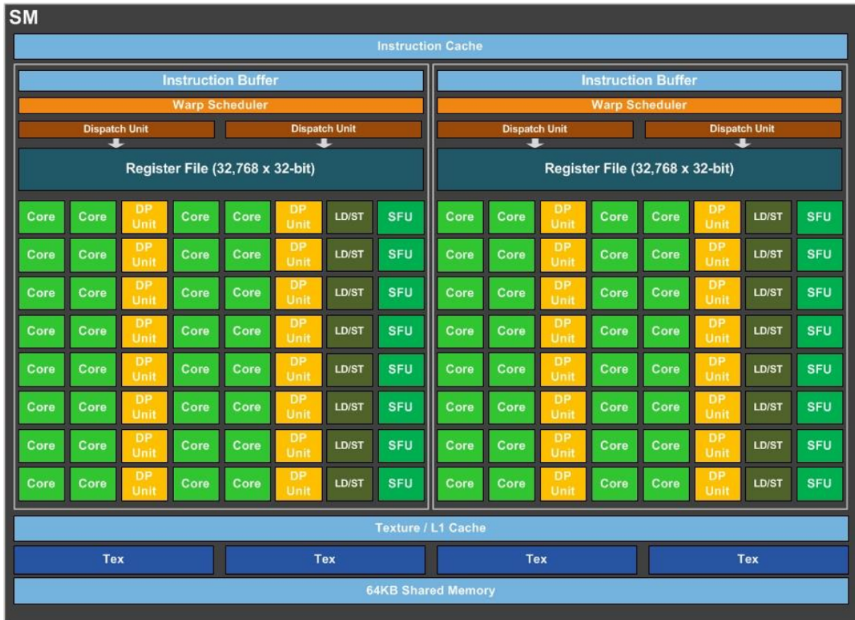
Figura 2.1: Exemplo de um Streaming Multiprocessor (SM) [21].
