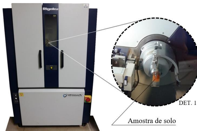
Figura 4.7. Difratorômetro de raios-X, sendo indicada amostra de solo em pó.
