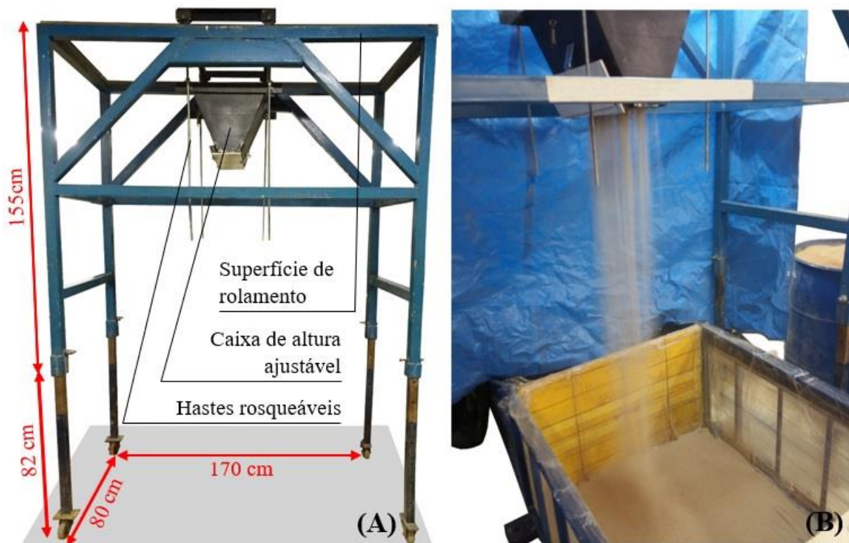
Figura 3.7. (A) Equipamento de deposição do material granular, sendo apresentado e (B) funcionamento do equipamento na montagem de ensaio de arrancamento.
