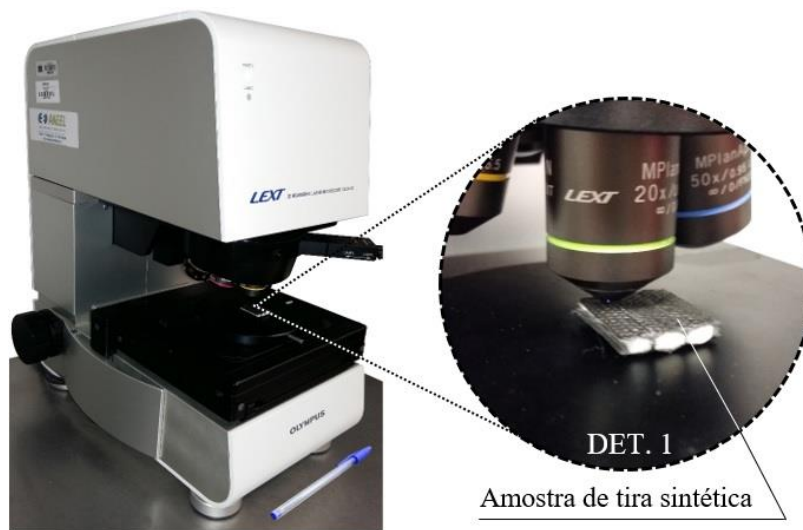
Figura 4.19. Microscópio Confocal a Laser empregado na avaliação da rugosidade superficial das tiras sintéticas (DET. 1).
