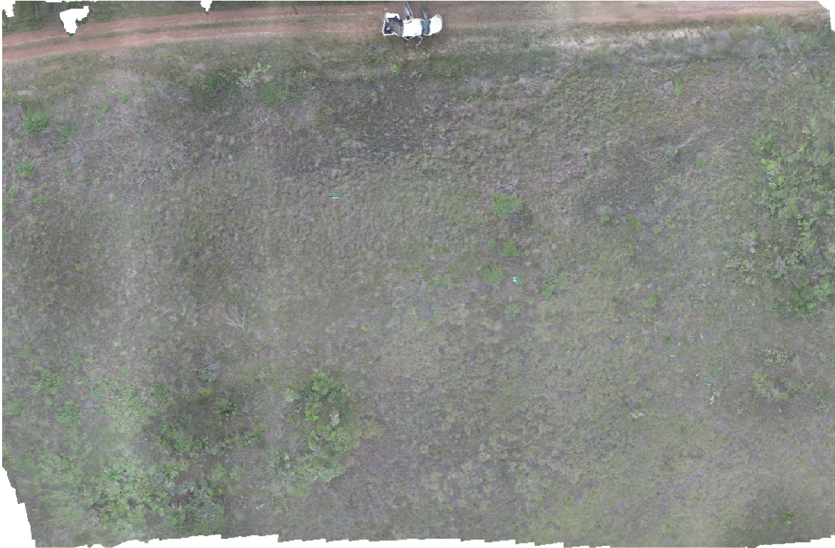
Figura 12 – Mosaico obtido pelo voo autônomo (2974x1956, resolução de 1,83 cm/pixel)
