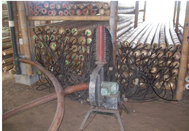
Figura 39 - Processo de secagem por injeção de ar quente realizado por Jorge Stamm na Colômbia. Foto: Autor (2010).
