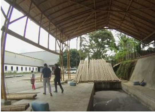
Figura 32 - Posicionamento dos colmos após a preservação para escoamento do líquido preservativo (Empresa Induguadua, Colômbia). Fotos: Autor (2014).
