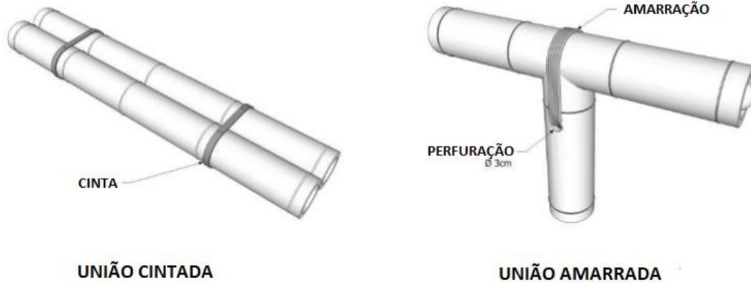
Figura 45 - Uniões cintadas e amarradas para bambu. Fonte: Norma peruana NTE.100 (2012) adaptada.
