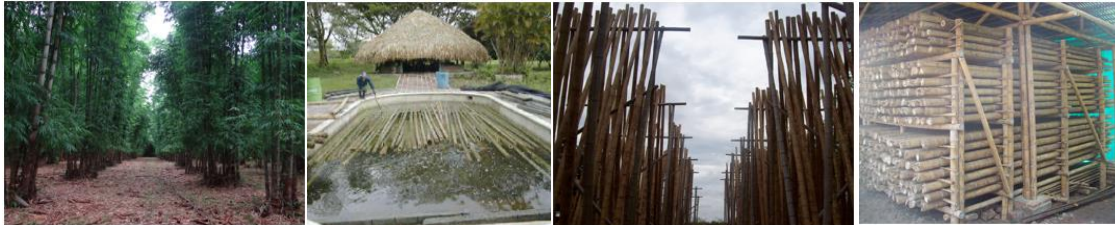
Figura 26 - Figura 26a: Plantio comercial de bambu. Figura 26b: Tratamento por submersão. Fonte: autor desconhecido. Figura 26c: Secagem em pátio. Figura 26d: Armazenagem e secagem. Fotos: Autor (2010-2014).
