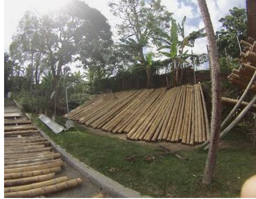
Figura 32 - Posicionamento dos colmos após a preservação para escoamento do líquido preservativo (Empresa Induguadua, Colômbia). Fotos: Autor (2014).
