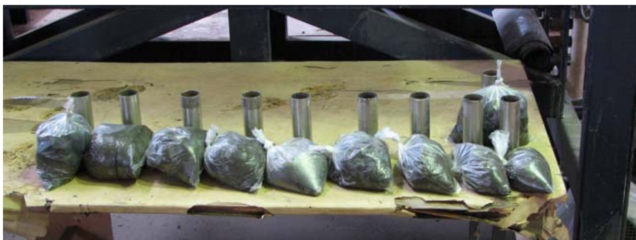
Figura H.14 – Amostras indeformadas e deformadas para caracterização em laboratório
