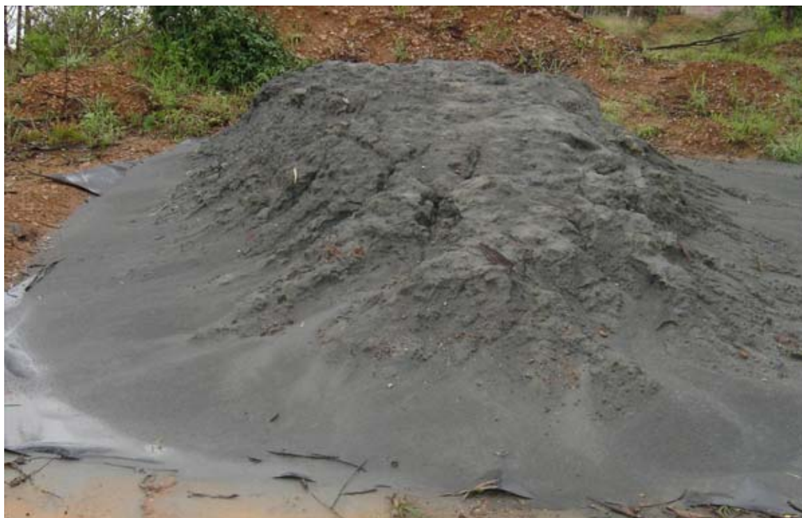
Figura H.4 – Estocagem do material de rejeito de minério de ouro em campo
