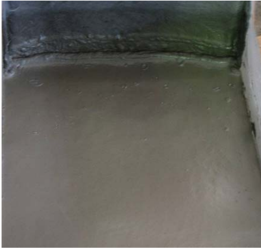
Figura H.11 – Final do ensaio, lama depositada ao final do canal de deposição hidráulica
