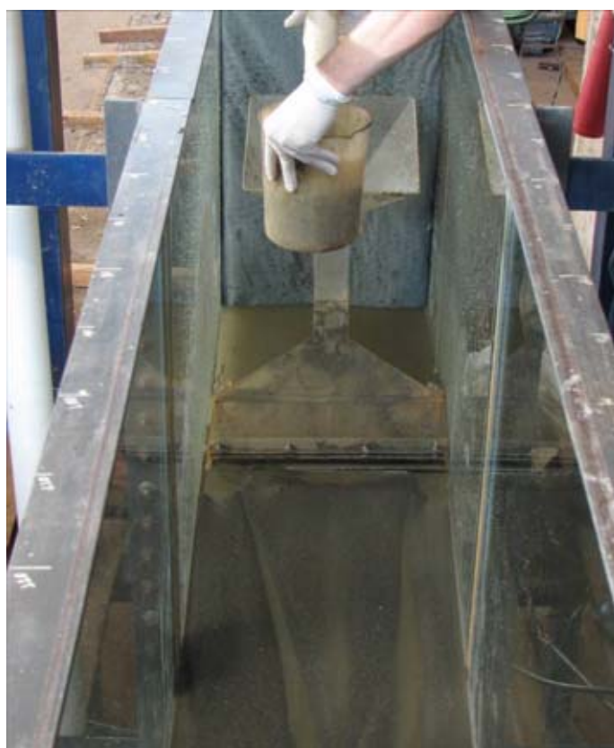
Figura H.8 – Controle da vazão durante a realização do ensaio de deposição hidráulica
