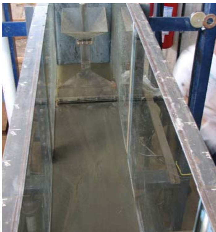
Figura H.7 – Execução do ensaio de deposição hidráulica
