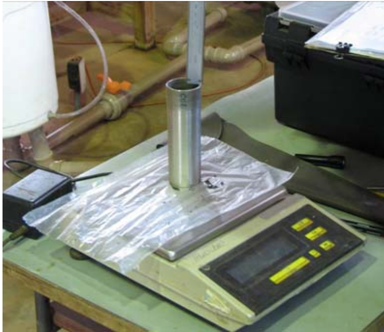
Figura H.15 – Determinação da massa úmida e das dimensões das amostras indeformadas
