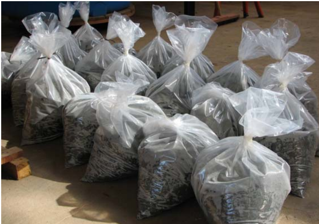
Figura H.6 – Pesagem do material de rejeito em sacos de 15kg para o controle inicial da concentração antes da realização do ensaio de deposição hidráulica
