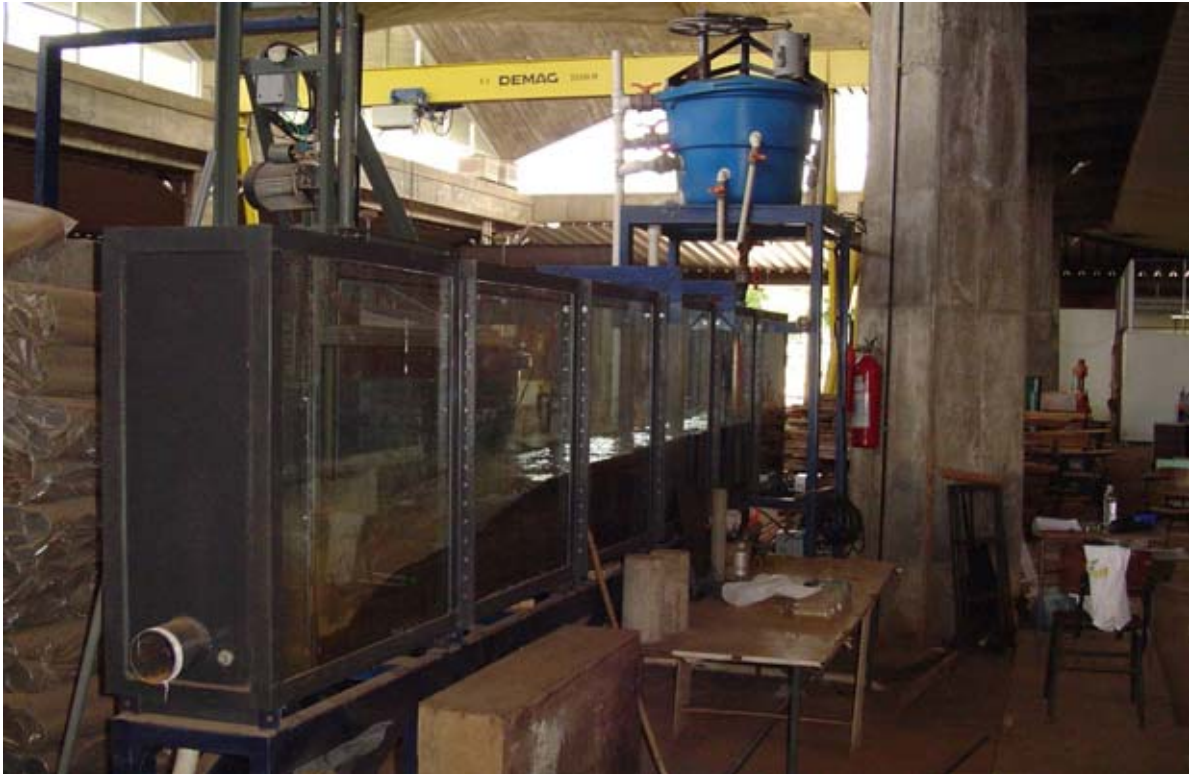
Figura H.1 – Visão geral do Equipamento de Simulação de Deposição Hidráulica
