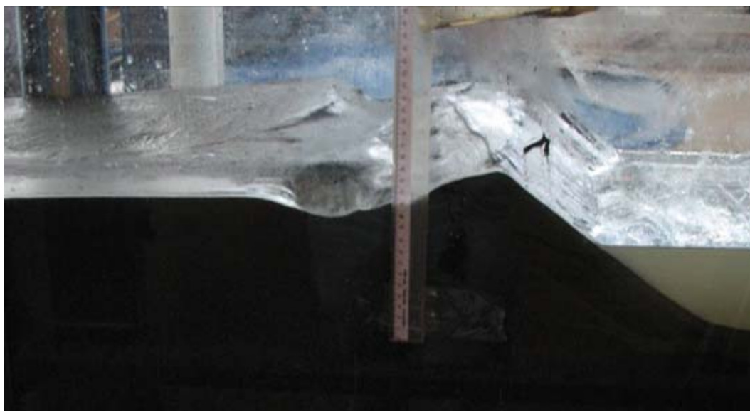
Figura H.10 – Final do ensaio, conformação da parte inicial da praia e controle da altura da crista
