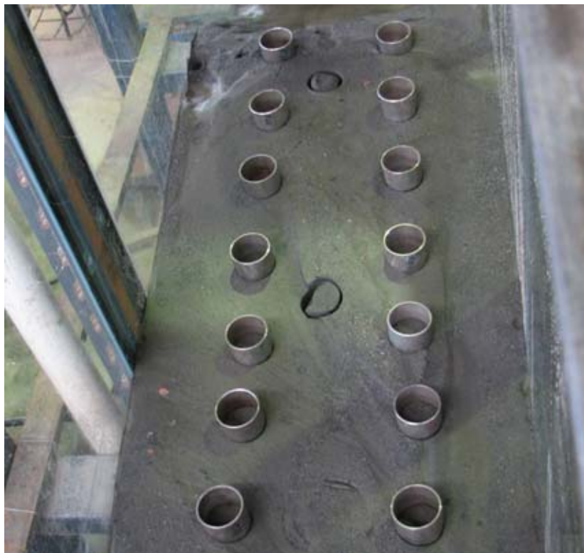
Figura H.12 – Coleta de amostras indeformadas ao longo da praia para caracterização
