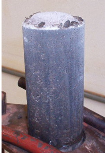
Figura 4.5 Amostra de rejeito congelado com índice de vazios inicial de 0,818 e grau de saturação de 100%.
