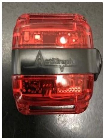
**Figura 10** – Modelo de acelerômetro triaxial usado no estudo (ActiGraph-GT3X+)
