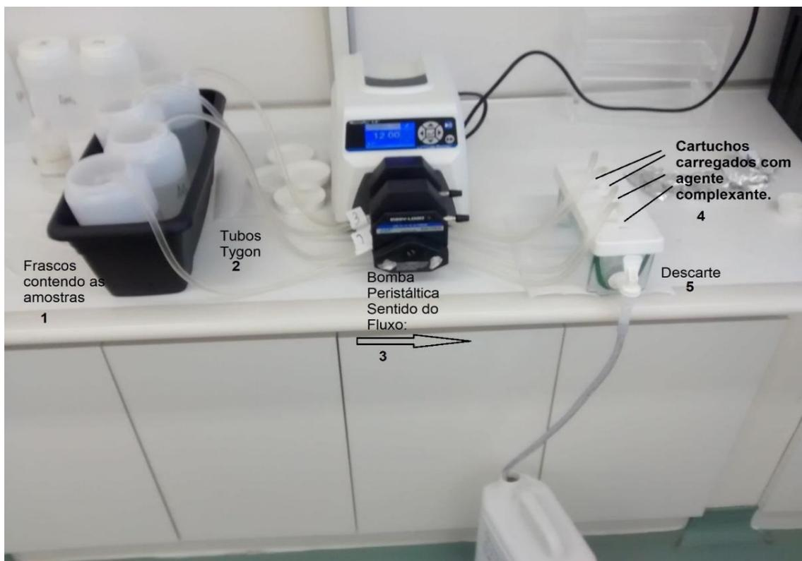
**Figura 4.** Sistema de extração das amostras. O sistema é composto por garrafas de PE contendo as amostras (1), tubos *Tygon* (2), bomba peristáltica (3), cartuchos carregados com agente complexante (4), descarte (5).
