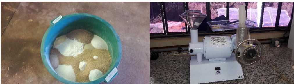
Figura 3. Mistura dos ingredientes e moedor de carne usado para peletização das dietas.
