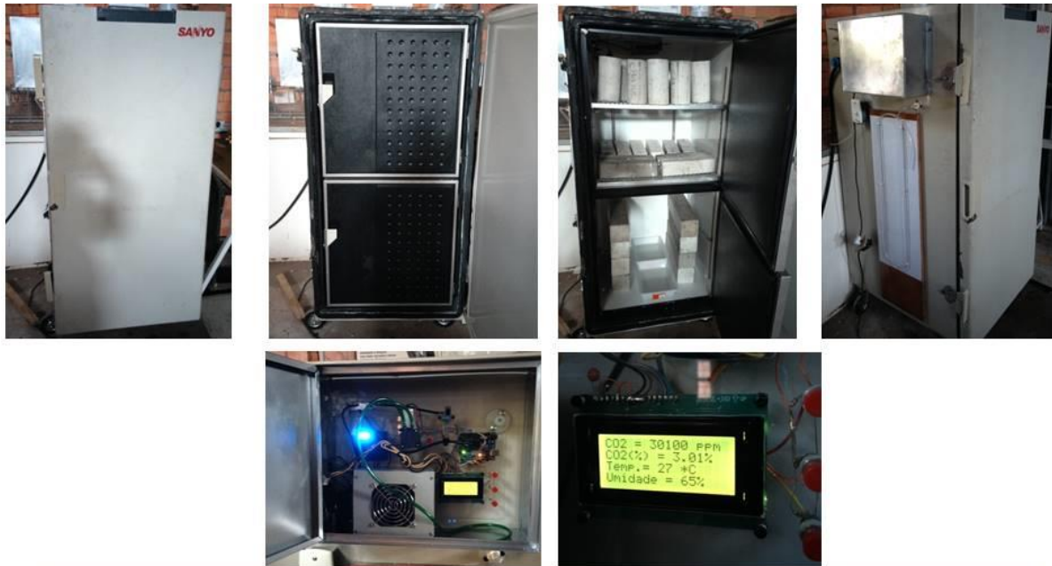
Figura 16 - Detalhes da câmara de carbonatação acelerada
