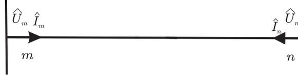
**Figura 1.1.** Tensões e Correntes do método de proteção de distância baseado no Modelo  $\pi$  Equivalente da linha
