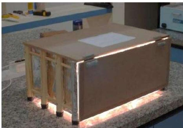
Figura 27: Exterior da caixa de envelhecimento [44].
