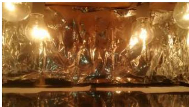
Figura 28: Interior da caixa de envelhecimento artificial forçado.
