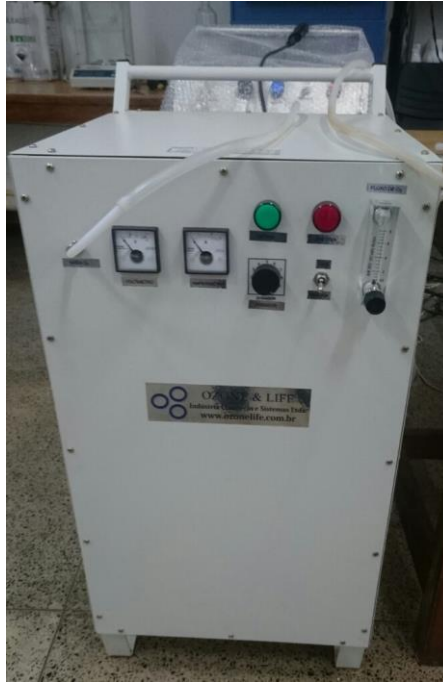
Figura 3. Gerador de ozônio com capacidade de produção de 10 g h -1 .
