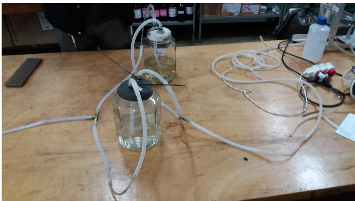
Figura 5 - Recipientes de vidro utilizados na Ozonização e forma de distribuição desses para otimização das análises.
