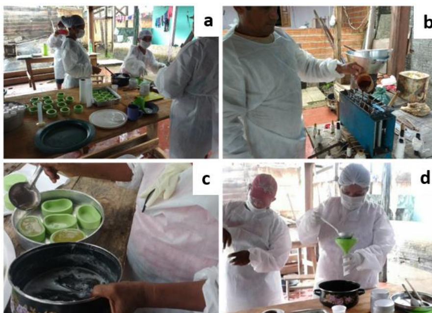
Figura 10 - Após a preparação dos produtos, se realiza o despejo nas formas e recipientes (a – Associados realizando a produção de sabonetes, b – Despejo da matéria-prima óleo de andiroba em máquina para produção de vela, c – Despejo do composto em forma para a produção de sabonete de andiroba, d – Despejo do composto de pomada de gergelim em recipiente para comercialização).
