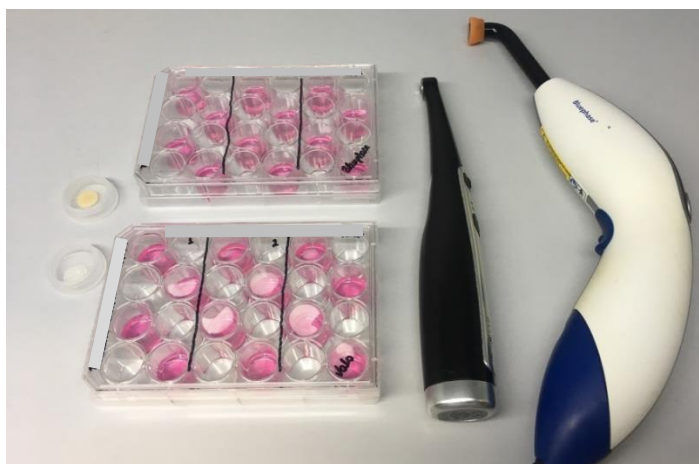
Figura 5: Ilustração das placas de cultivo de 24 poços juntamente com os discos de dentina e resina e os aparelhos LED Valo e Bluephase
