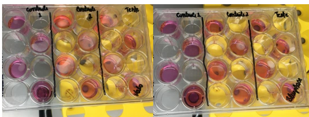
Figura 4: Demonstração do procedimento de fotopolimerização através da base da placa de cultivo celular de 24 poços.
