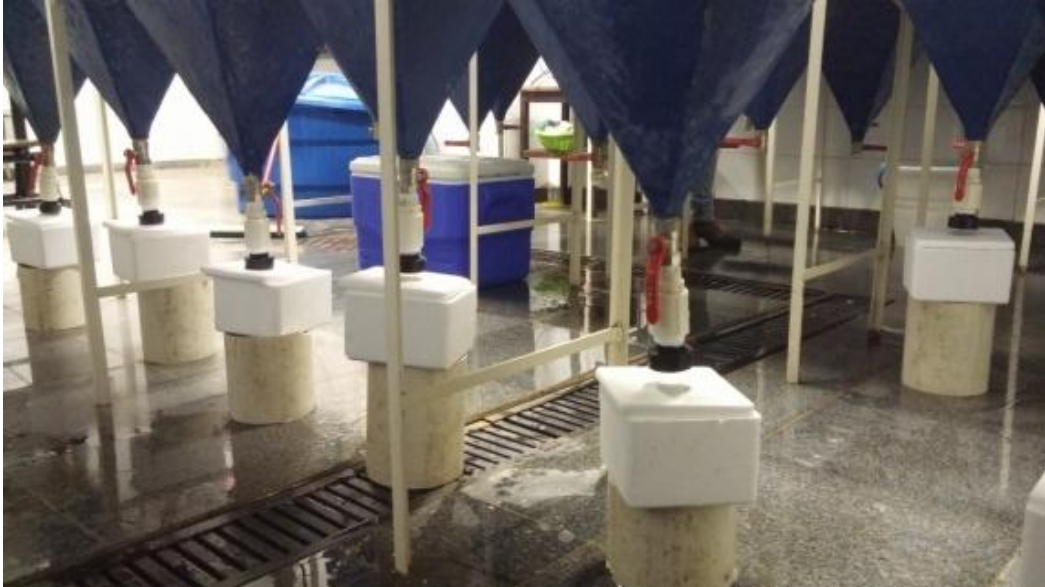
Figura 9. Caixas de coletas de fezes com tubo coletor em recipiente com gel utilizadas na avaliação da digestibilidade de dietas com diferentes níveis de farinha de resíduo de peixe para alevinos de pacamã.
