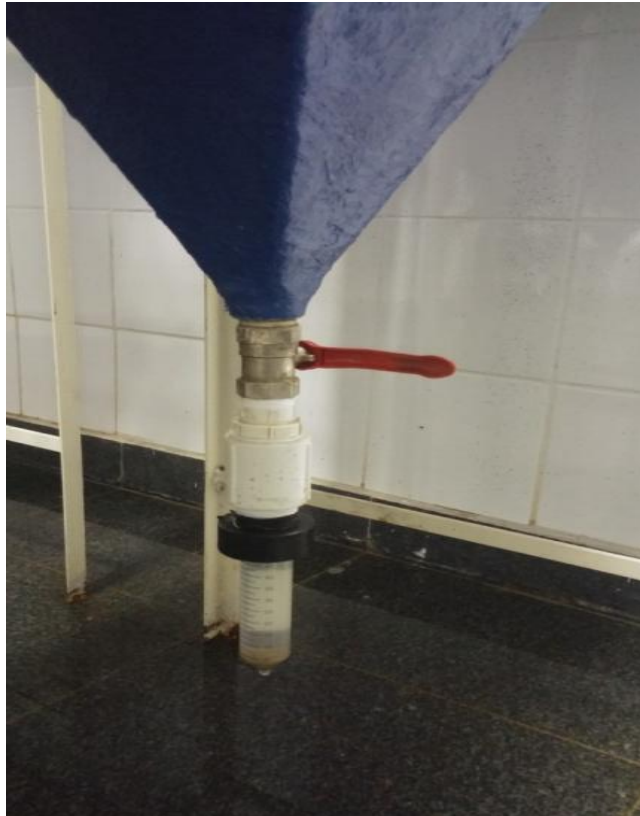
Figura 8. Tubo falcon para coleta de fezes instalado em sistema GuelphModificado para determinação de digestibilidade em experimento de avaliação de dietas para alevinos de pacamã.
