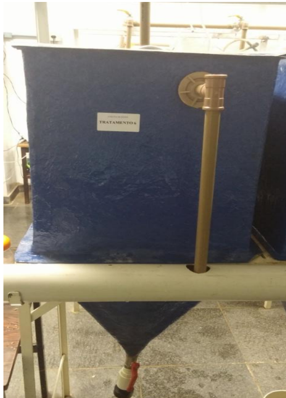
Figura 4. Unidade experimental constituída por uma caixa de fibra de vidro com fundo cônico com capacidade cúbica de 80 litros de água aonde foram acondicionados alevinos de pacamã para avaliação de rações com diferentes níveis de inclusão de farinha de resíduo de peixe.
