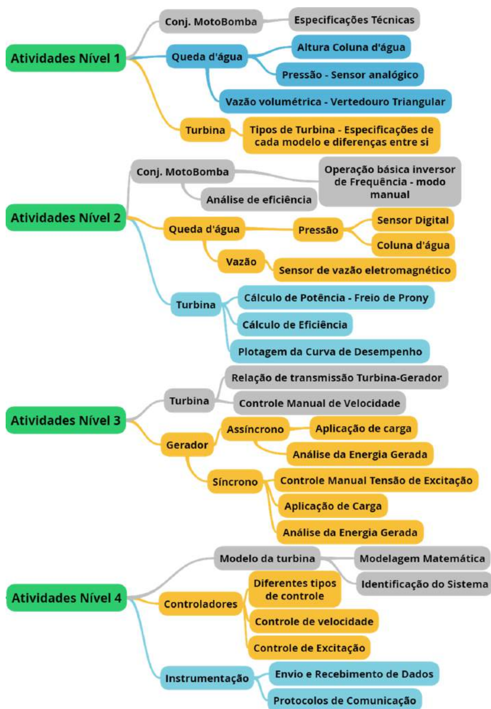
Figura 12 – Atividades desenvolvidas nos 4 níveis metodológicos da Bancada de Sistemas Hidrelétricos da FGA-UnB.
