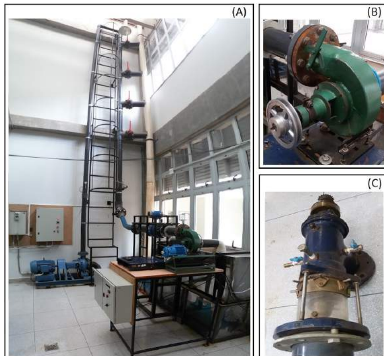
Figura 11 – (A) Bancada Didática de sistemas hidrelétricos, (B) Turbina Indalma e (C) Turbina Kaplan.
