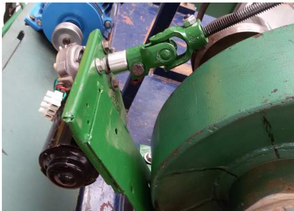
Figura 88 – Suporte mecânico, acoplamento do eixo do motor e junta universal tipo "cruzeta".
