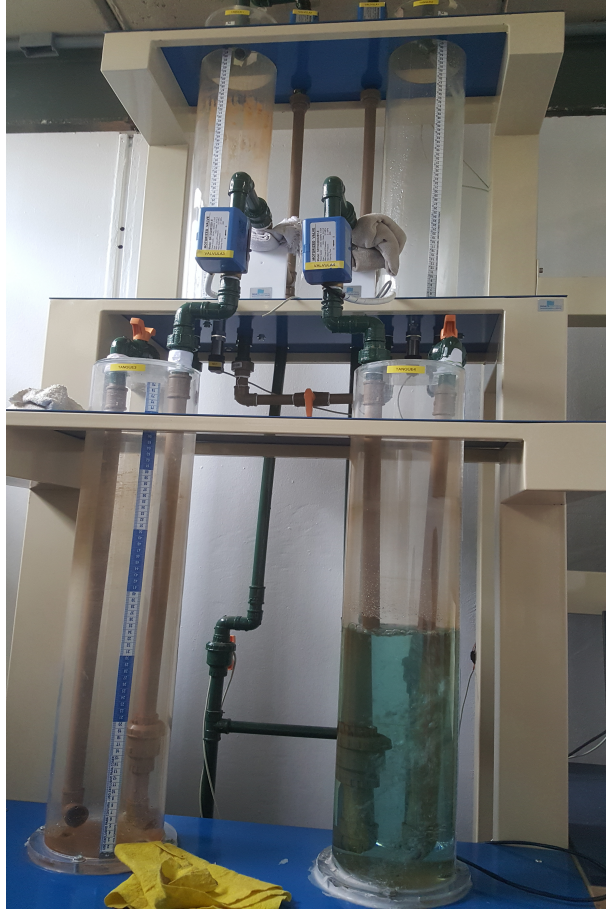
Figura 5.22: Bancada de quatro tanques usada para a realização dos testes reais
