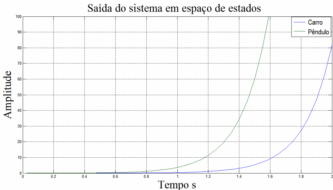
Figura A.4: Saída do sistema em função do espaço de estados para o carro e o pêndulo. [12]
