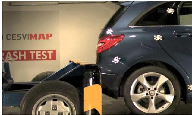
Figura 2-6: Teste de colisão traseiro, efetuado por um trenó.
