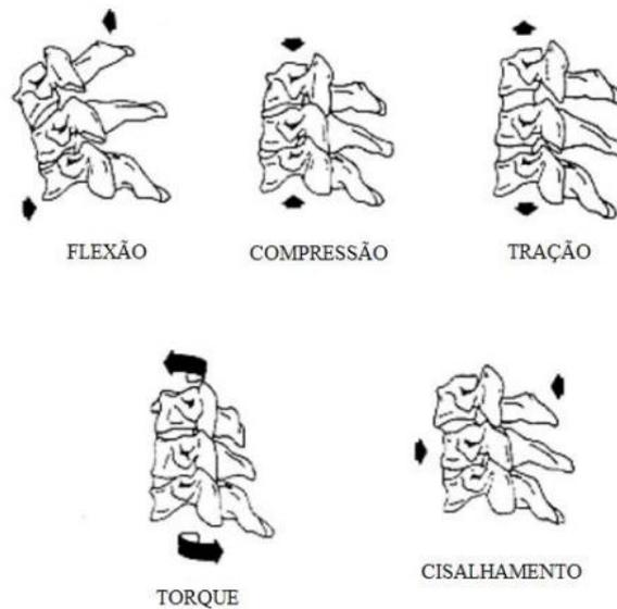
Figura 2-16: Descrição de engenharia para as cargas no pescoço.
