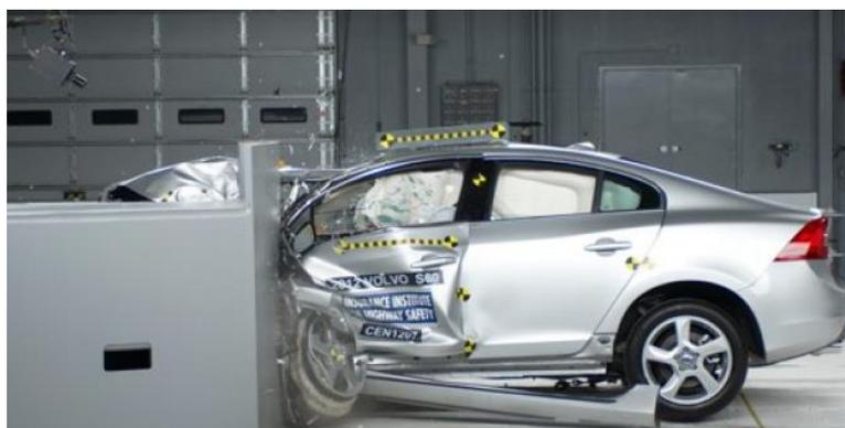
Figura 2-4: Teste de colisão frontal contra uma barreira deformável.
