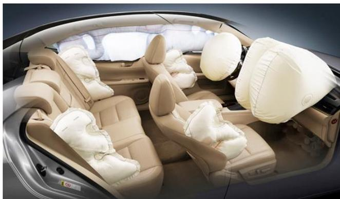
Figura 2-2: Veículo equipado com múltiplos *airbags*.
