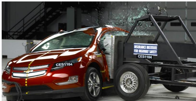
Figura 2-5: Teste de colisão lateral, efetuado por um trenó, para medir a proteção passiva lateral do veículo.
