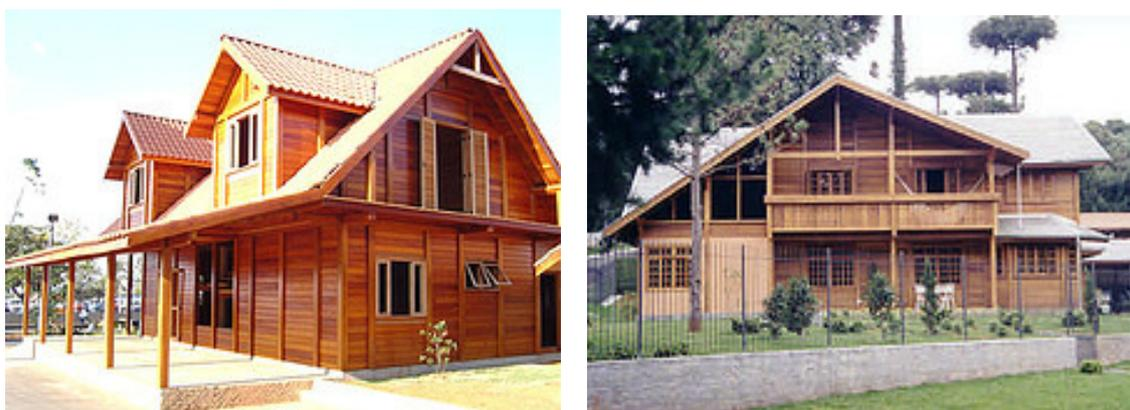
Figura 123 – Casas de madeira com paredes em peças maciças com encaixe do tipo macho-e-fêmea. Fonte: CAMPER (2007).
