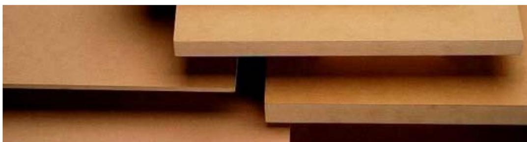
Figura 13 – Modelos de chapas de MDF com espessuras variando de 3 a 30mm.
