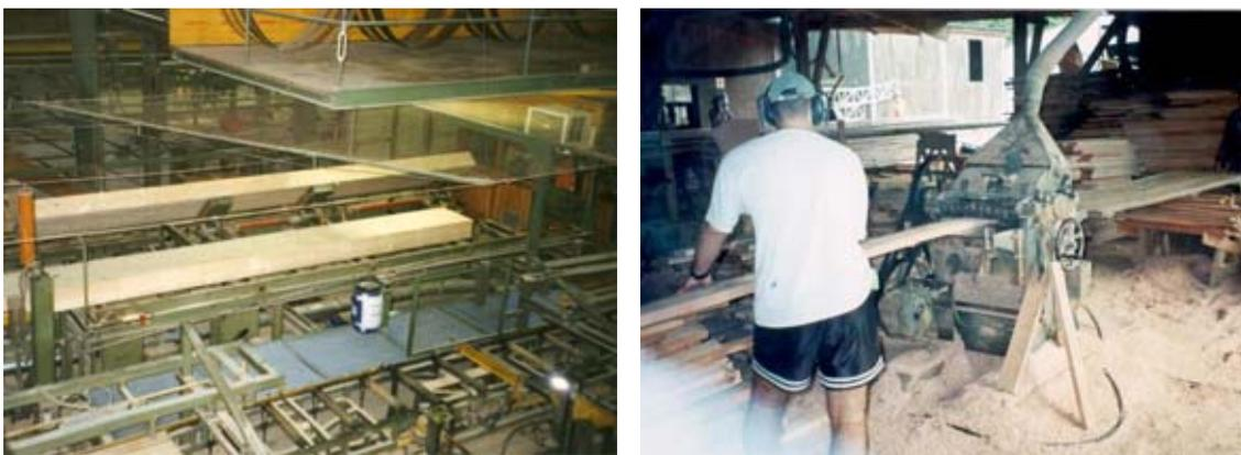
Figura 19 – Produção automatizada de MLC na Áustria e produção manual no Rio Grande do Sul. Fonte: MELLO (1998-2000).
