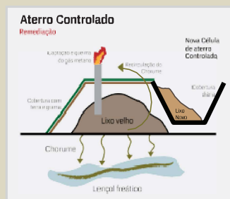
Fig. 5. Contaminação do lençol freático pelo chorume produzido, apesar da captação dos gases produzidos e da cobertura dos resíduos com terra em um aterro controlado.
