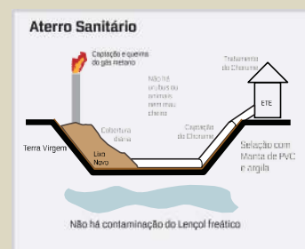
Fig. 6. Proteção do lençol freático e do solo no entorno; captação e queima dos gases produzidos; captação do chorume para tratamento.
