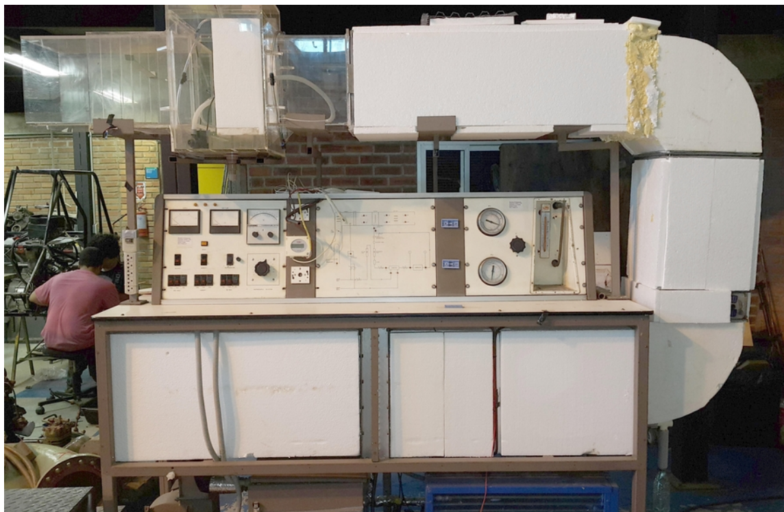
Figura 30 – Bancada Cussons com revestimento isolante térmico
