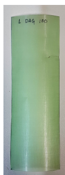
Figura 54 – Amostra PET lixado com lixa d’água granulação 100
