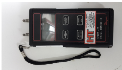
Figura 47 – Manômetro diferencial Dwyer® Série 477-1
