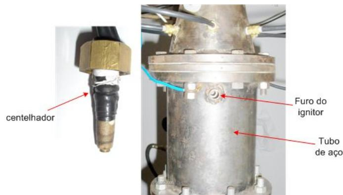
Figura 3.10 – Centelhador e seu posicionamento no combustor.
