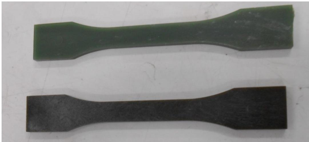
Figura 3.16 – Corpos de prova para ensaio de tração de PS (Em cima) e compósito de PS com fibra de bagaço de cana-de-açúcar (Embaixo).
