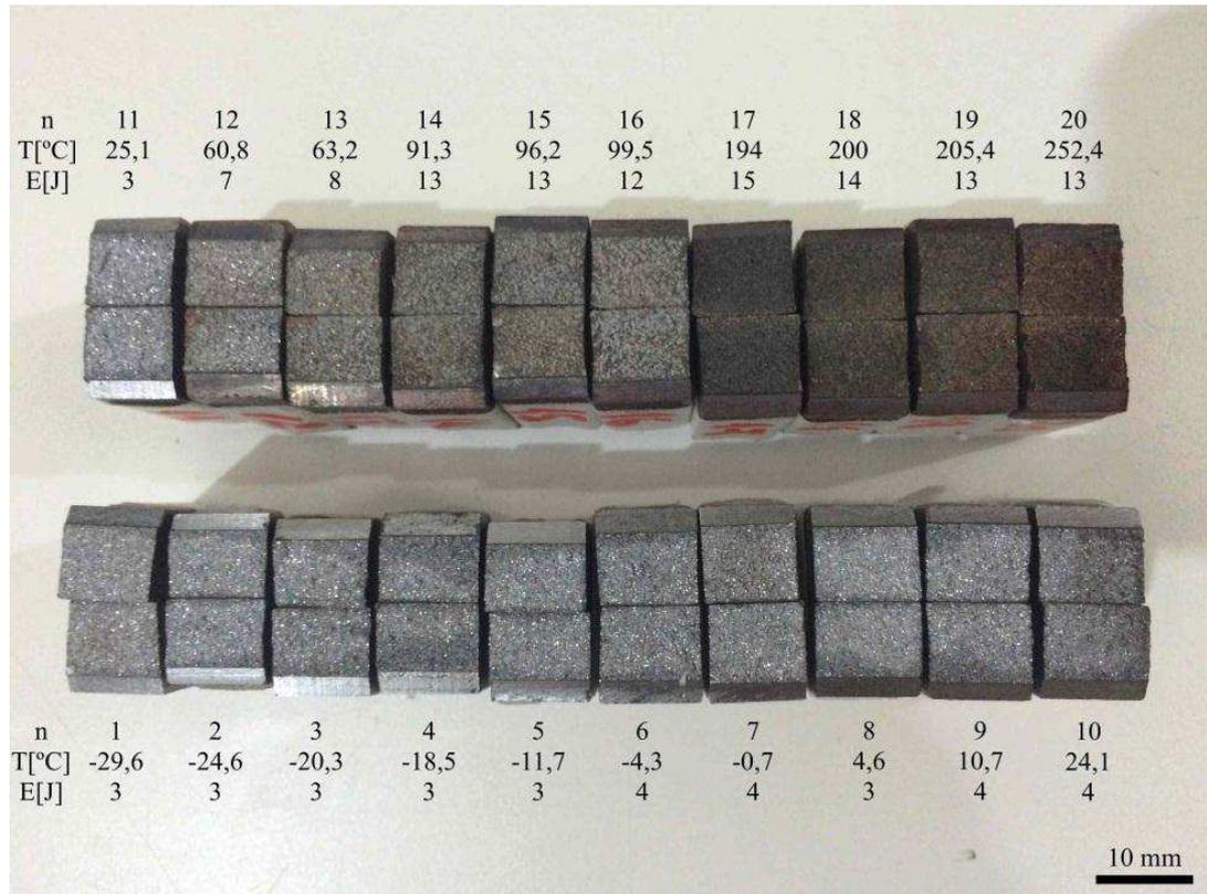
Figura 4.6 – Aparência das faces fraturadas dos corpos de prova de GGG40.
