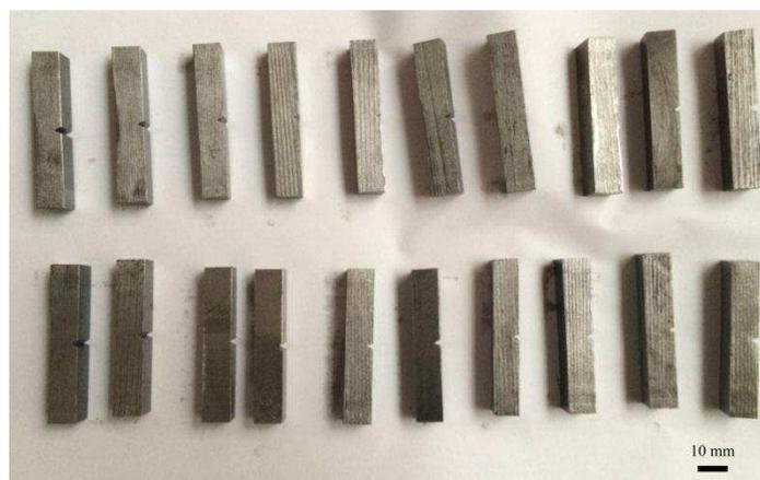
Figura 3.8 – Corpos de prova de GGG 40 antes do ensaio de impacto.
