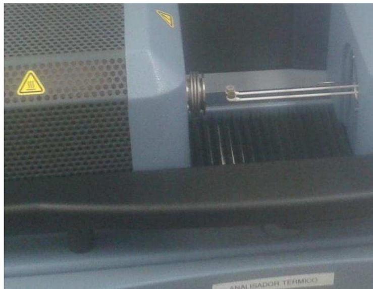
Figura 3.3 – Cadinho de alumina na análise de TGA.
