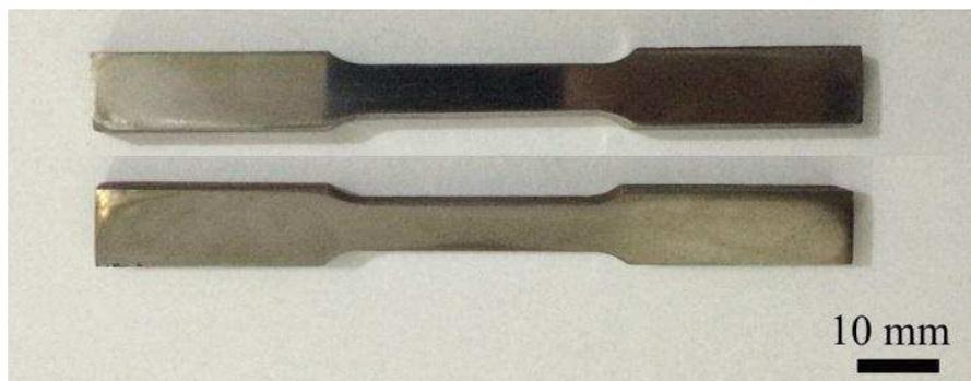
Figura 3.13 – Corpos de prova retangulares de GGG 40 para ensaio de tração.
