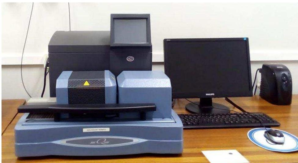
Figura 3.2 – Analisador térmico SDT Q600 da TA Instruments.
