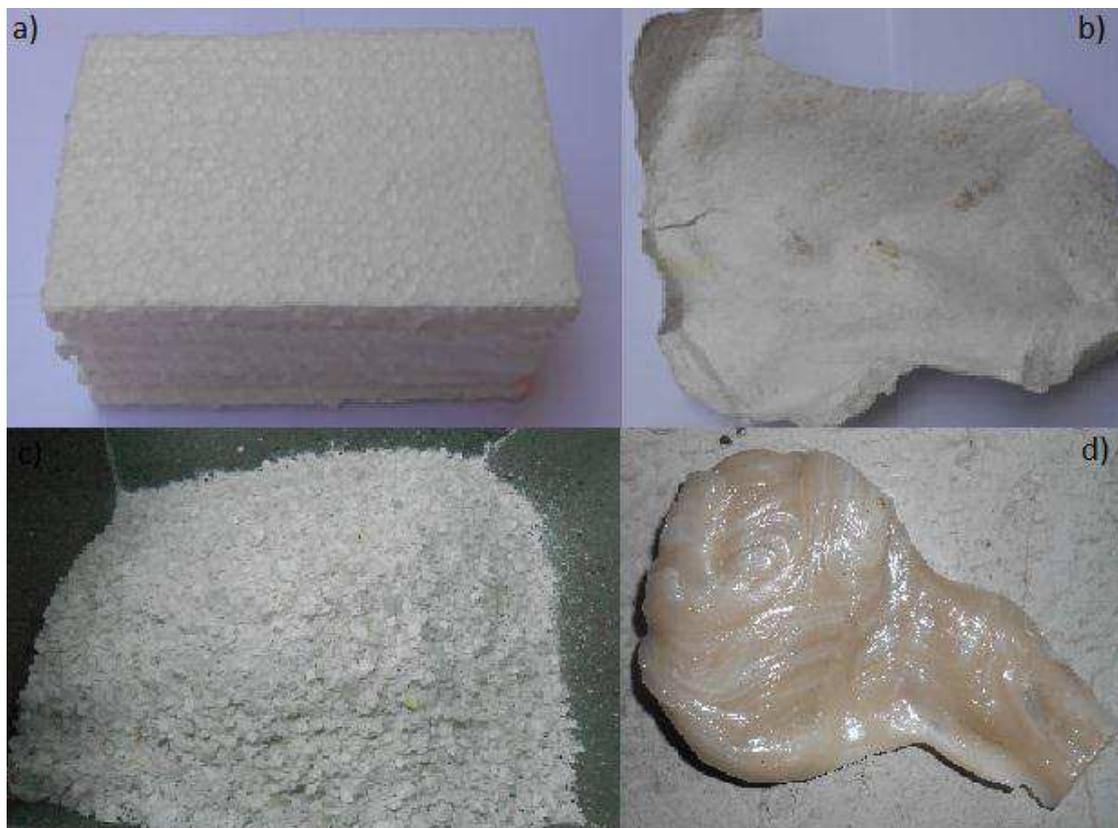
Figura 3.1 – Processos do material para obtenção do PS: a) EPS reciclado, b) Material após prensado, c) PS triturado, d) PS depois da extrusão.
