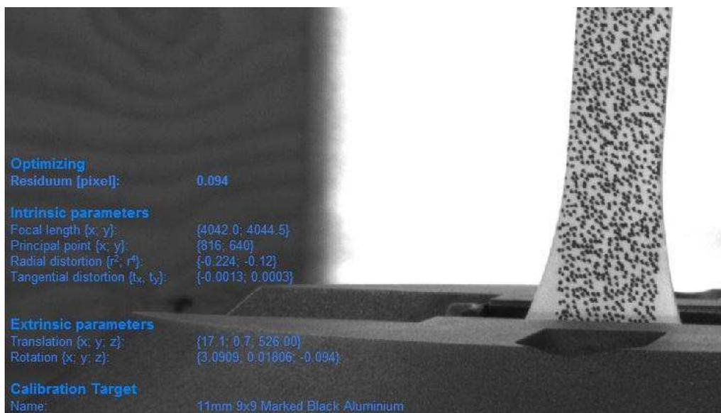
Figura 3.20 - Parâmetros de calibração e resíduo do sistema de CDI.
