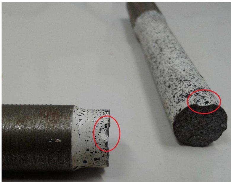
Figura 4.10 – Corpo de prova *g* com evidente falha em forma de bolha no lugar da fratura.
