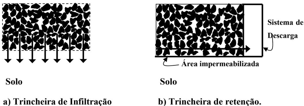
Figura 2.7 – Modelo de Trincheiras de Infiltração e retenção. (Azzout et al, 1994).
