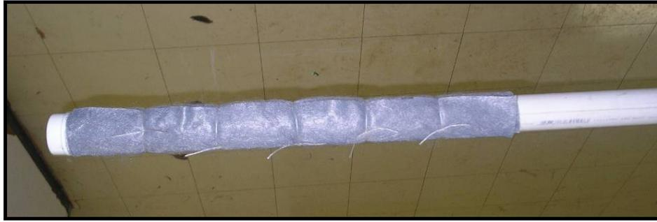
Figura 3.34 – Procedimento de Montagem do Piezômetro tipo Casagrande (fechamento).
