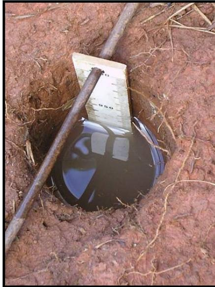
Figura 3.8 – Furo de sondagem para o ensaio e régua graduada
