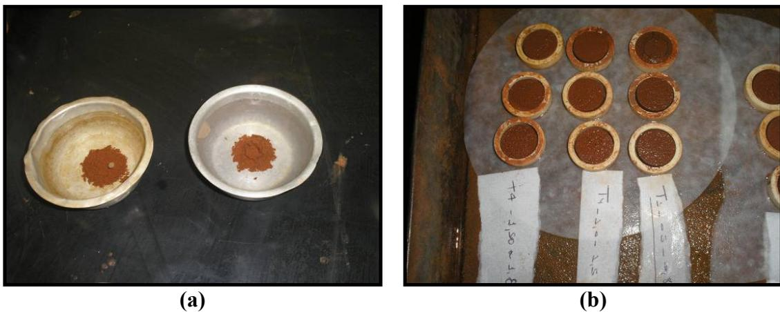
Figura 3.17 –(a) – Desagregação do solo; (b) – ensaio de absorção nas pastilhas.
