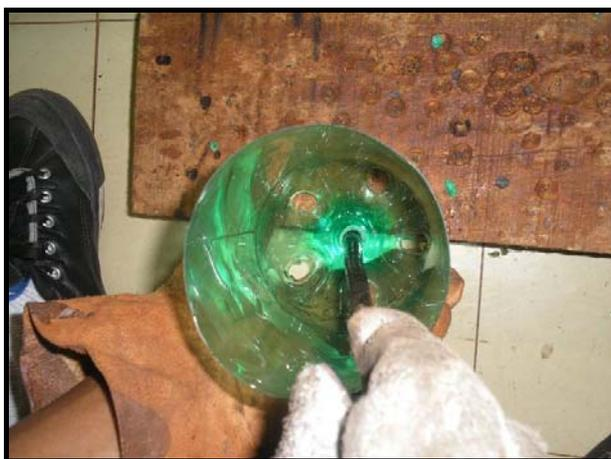
Figura 3.31 – Processo de queima, determinando os furos na parte inferior da garrafa cortada.
