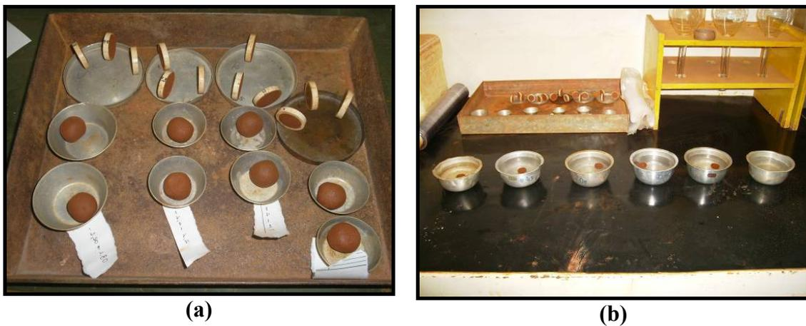
Figura 3.16 – (a) – Esferas e pastilhas do solo ensaiado; (b) – Imersão das esferas para a observação de desagregação.
