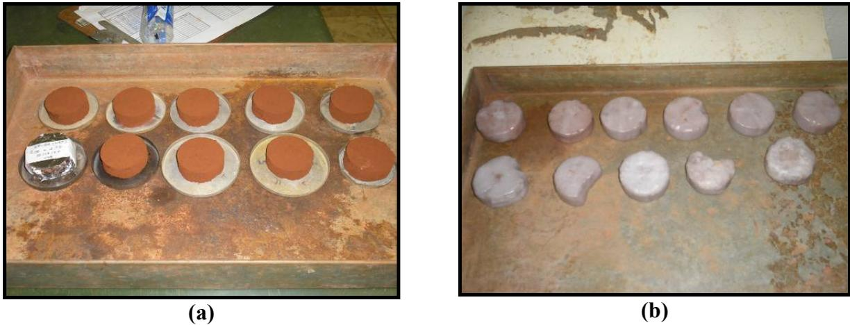
Figura 3.19- (a) – Corpos-de-prova no processo de secagem e de umedecimento; (b) – Corpos-de-prova com parafina, para a determinação do  $e_f$ .
