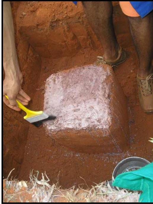
Figura 5.8 – Escavação e retirada de blocos.
